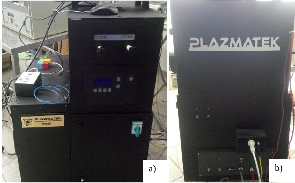
Şekil 3.1. kHz, darbeli DC güç kaynaklarının resmi, a) ön yüz, b) yan yüz ve kHz, darbeli DC, akış hızı ayar alanı
