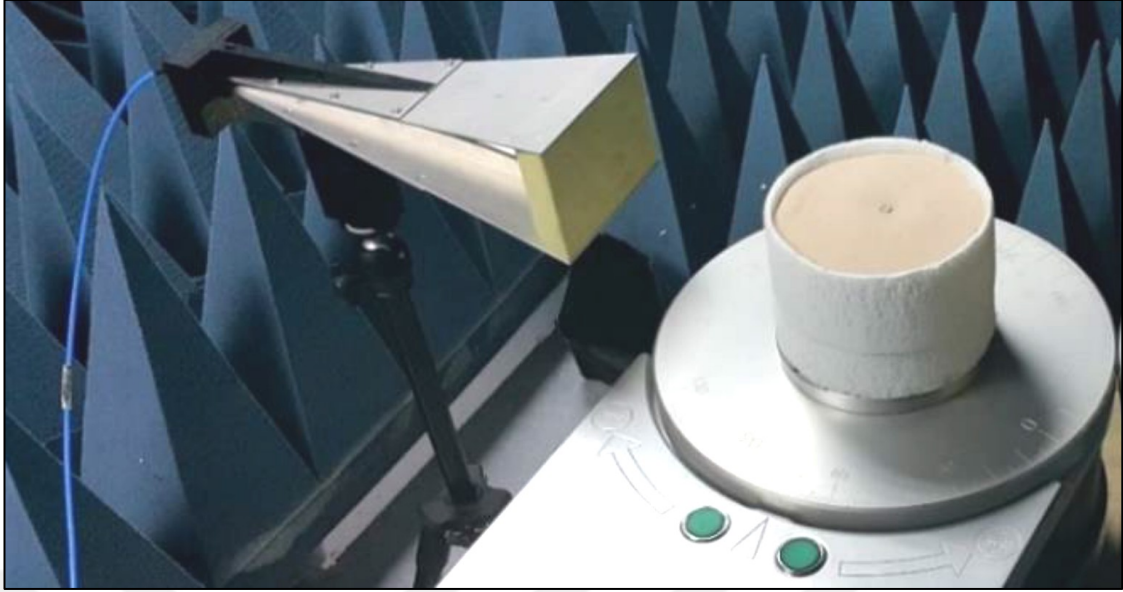
Şekil 1.7. Monostatik teknikle yapılan bir ölçüm (Biçer ve Akdağlı 2017).
