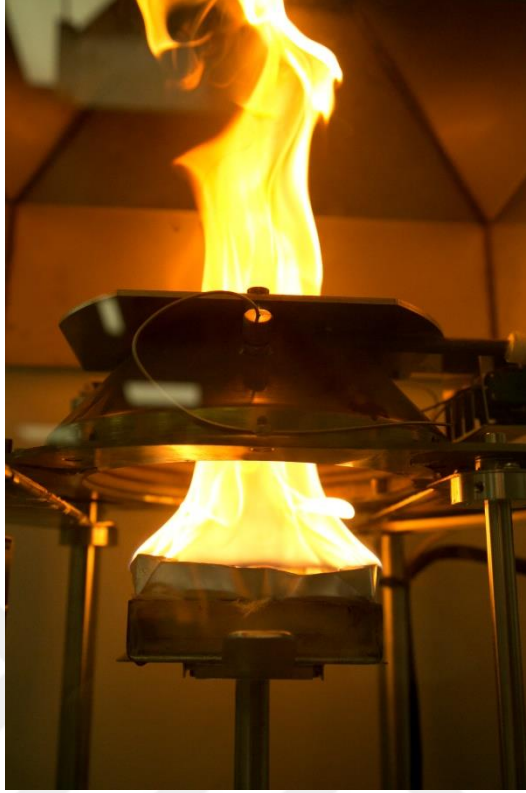
Şekil 3.15. Konik kalorimetre testi sırasında yanan numune fotoğrafı
