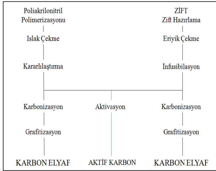
Şekil 1.15. PAN temelli ve zift temelli karbon elyaf üretim şeması (Chung, 1994)
