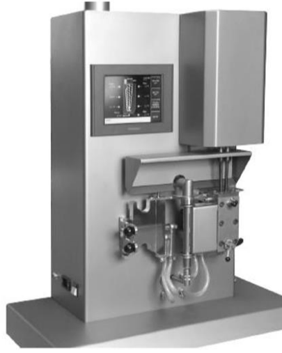
Şekil 2.1. Çift vidalı, dikey mini ekstrüder
