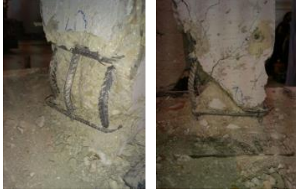
Şekil 5.52. Kolon alt ucunda boyuna donatıda burkulma (BÇN-10)
