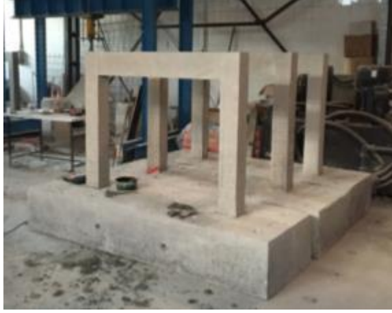
Şekil 4.6. Üretilen betonarme çerçeve numunelerine ait bir görünüm
