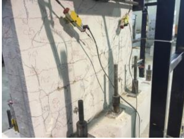
Şekil 5.59. Güçlendirilen dolgu duvar yüzündeki hasar oluşumu (BÇN-11)
