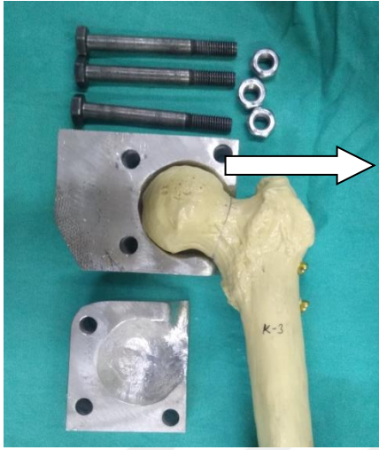
Resim 10: Özel olarak femur başını anatomik olarak içine alan baş tutucu aparat
