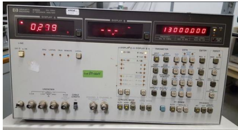
Resim 4.7. Hewlett Packard 4192A LF empedans analizörü
