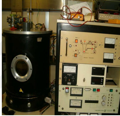
Resim 4.3. Yüksek vakum pompalı kaplama ünitesi
