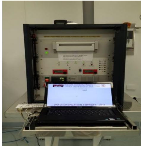
Resim 4.4. Hızlı termal tavlama ünitesi (Rapid Termal Annealing-RTA) (Karabulut, 2014)
