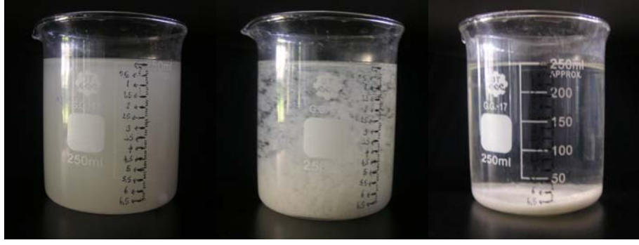
Şekil 4.17. a) Ham mermer atıksuyu, b) alüminyum elektrotların kullanıldığı EC prosesi sonrası c) 3 dk bekleme süresi sonunda mermer atıksuyunun EC hücresindeki durumu
