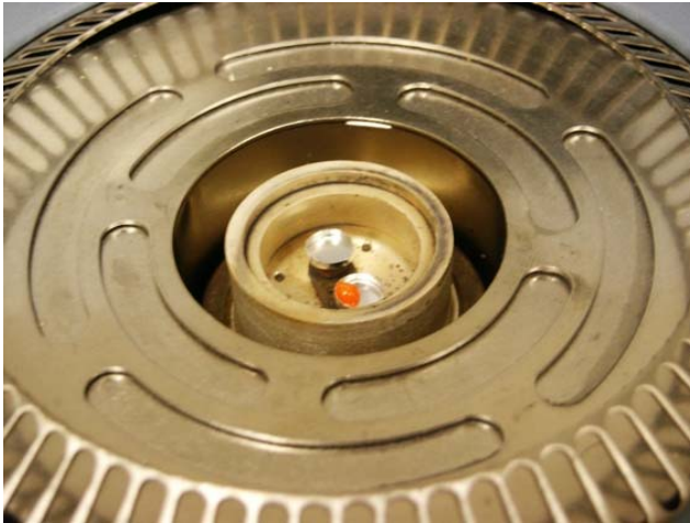
Şekil 3.7 DSC cihazındaki alüminyum kaplardan birine test edilen mouthguard malzemesi yerleştirilmiş diğeri kontrol olarak kullanılmıştır
