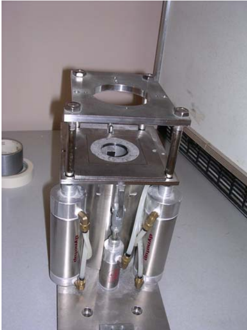
Şekil 3.4 Küçük (3.81 cm) çaplı alt destek halkasına karşılık geniş (7.62 cm) çaplı üst destek halkası
