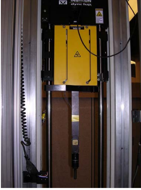
Şekil 3.3 Güç çevirici (transducer) içeren çentik açıcı aygıt (indenter)
