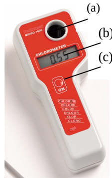
Resim 1.1. Palintest Micro 1000 [1] (a) Test odacığı (b) LCD ekran (c) Düğme (ON Button)
