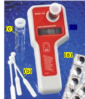
Resim 1.2. Palintest Micro 1000 [2] (a) DPD No: 1 tabletler (b) Karıştırma çubuğu (c) Test tüpü (10 ml)
