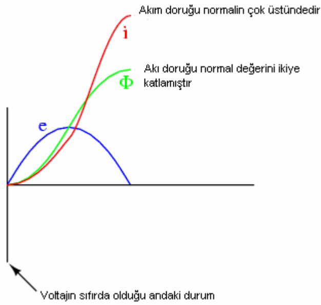
Şekil 2.12 Voltajın sıfır olduğu an için akı – akım ilişkisi
