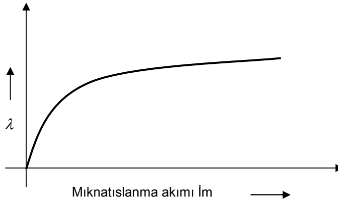
Şekil 2.3 Demir nüveli transformatörün tipik mıknatıslanma eğrisi
