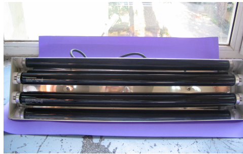
Şekil 3.2. Fotokatalitik proseste kullanılan UVA (UVP Upland, CA 91786, Model XX – 20 BLB) ışık kaynağı.
