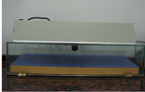
Şekil 3.1. Bakterilerin fotokatalitik inaktivasyonu için kullanılan cam düzenek
