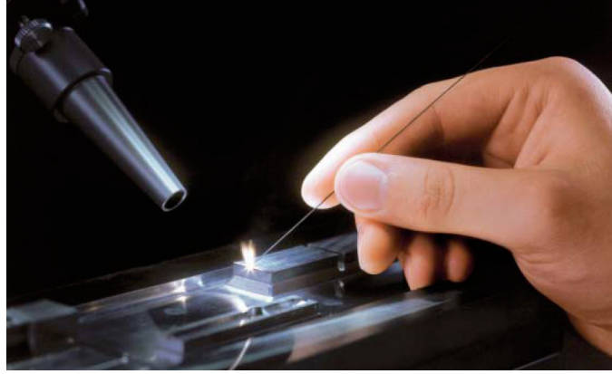
Şekil 7.24 Lazer kaynağı ile dolgu
