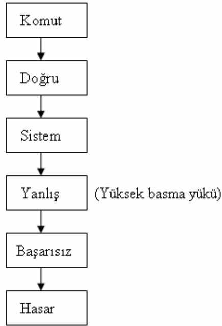
Şekil 10.6 Seramik kalıp hasar akış diyagramı
