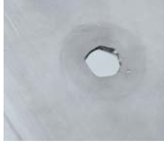
Şekil 9.9 Patlayan sıcak yolluk memesi
