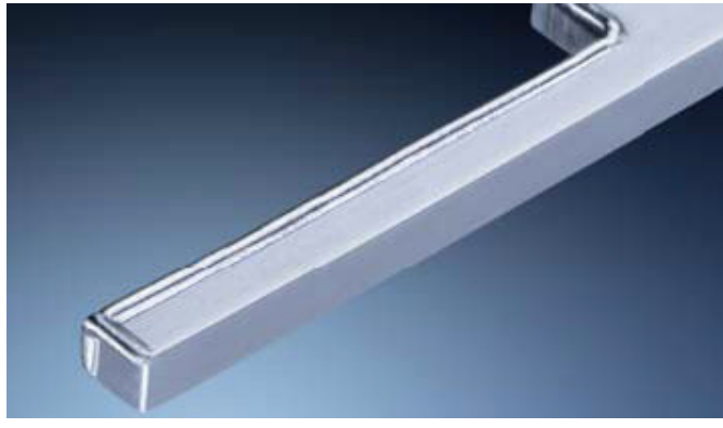
Aluminyum 7075 üzerine AlSi5 tadilat kaynağı
