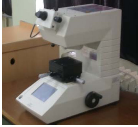
Şekil 10.4 Mikrosertlik ölçümlerinin yapıldığı cihaz.
