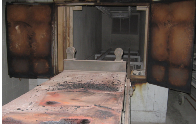
Şekil 10.13 Hasarlı kalıpların kaynak işleminden önce temizlenmesi için fırında bekletilmesi
