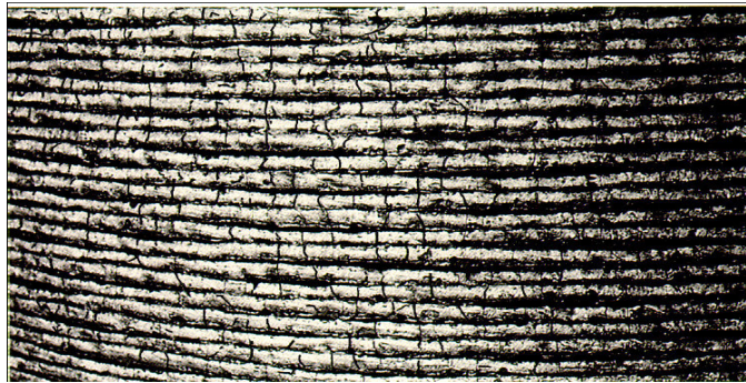
Şekil 6.1 Yüksek krom-karbürlü alaşımlarda gerilim çatlakları
