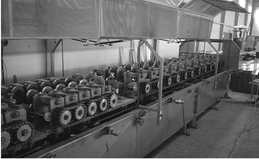
Şekil 2.14 Profillerin Çekilmesi Esnasında Bükme İşlemini Yapan Kısım
