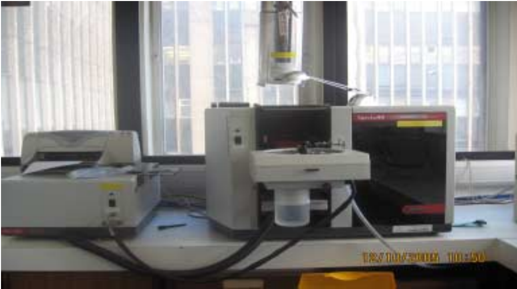
Şekil 3.4. Varian 220Z GFAAS Sistemi
