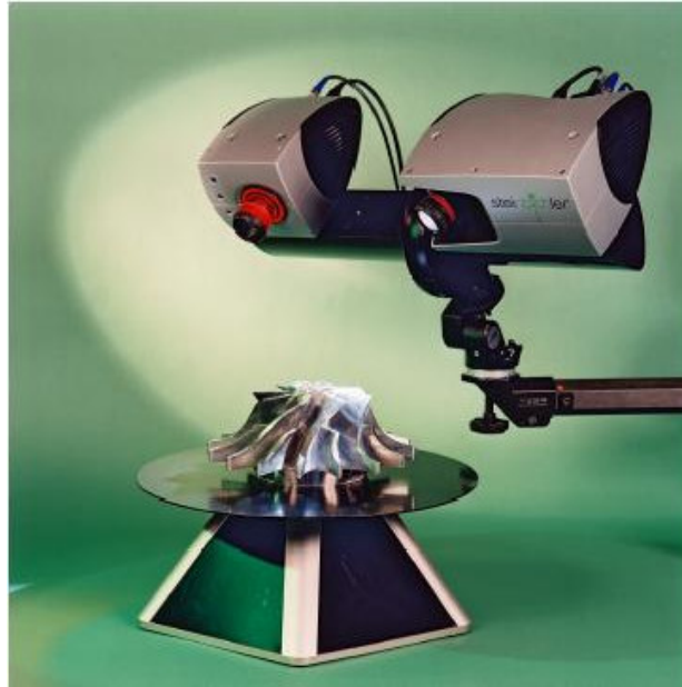
Şekil III.7. Steinbichler COMET IV Tek Kameralı Optik Tarama Sistemi
