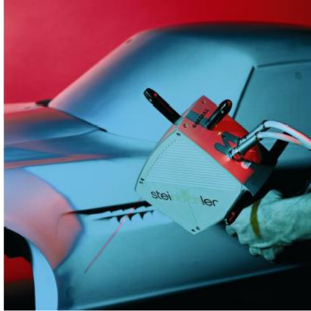
Şekil III.6. Steinbichler T-SCAN Lazer Kesitli Tarama Sistemi
