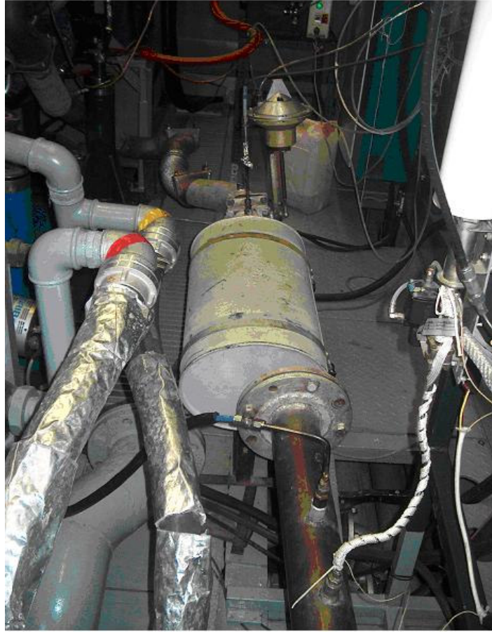
Şekil 2.6 Egzoz numunesi alma düzeni
