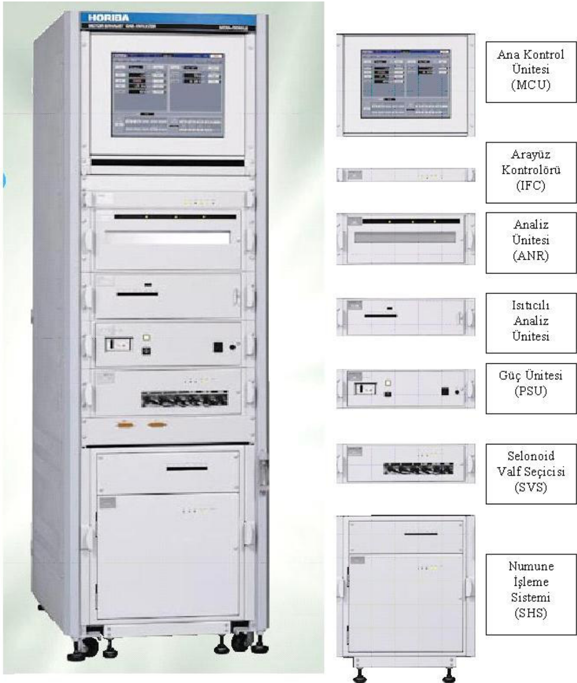
Şekil 2.5 Gaz analiz cihazının yapısı
