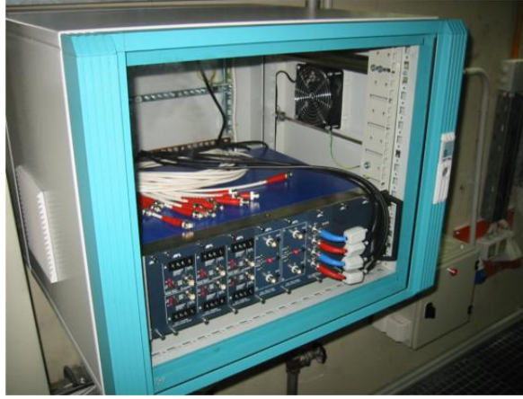
Şekil 2.10 Silindir içi basınç ölçme düzeni veri toplayıcısı
