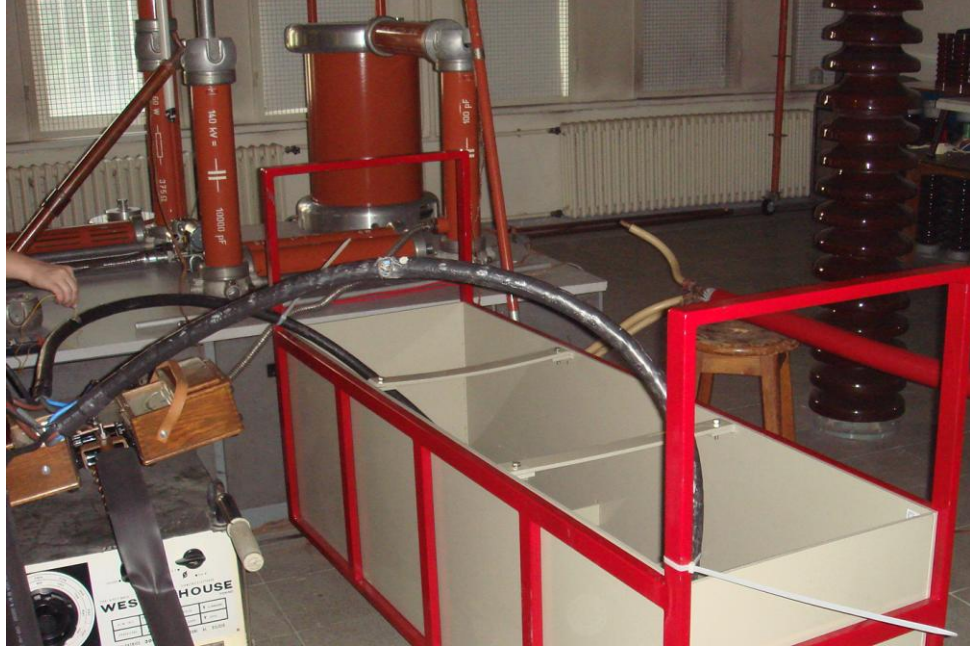
Şekil V.23 0.6/1kV kablo için kurulan deney düzeneği
