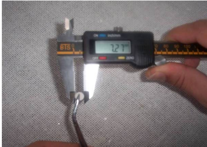
Şekil 7.8 Dental simanların boyut ölçümüne ait görüntü
