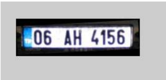
Şekil 3-7 Plakanın dört kenarına döndürmenin sonucu siyah bölge eklenmiş görüntü.
