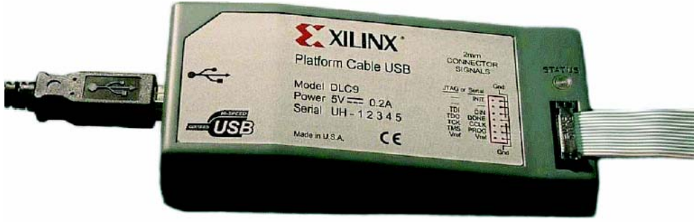
Şekil 1 FPGA'e yazılım yüklemek için kullanılan USB – JTAG kablosu
