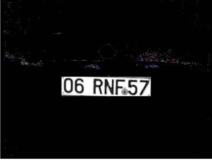
Şekil 3-39 Öznitelik çıkarma işleminden sonra plaka çıkış video görüntüsü
