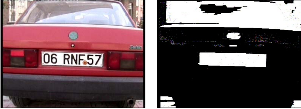
Şekil 3-33 Gabor Filtrenin öncesi ve sonrası
