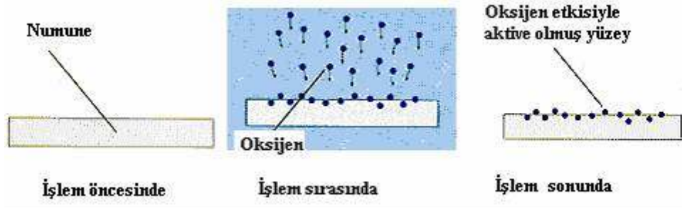
Şekil 3.13 Plazma etkisiyle oluşan yüzey aktivasyonu
