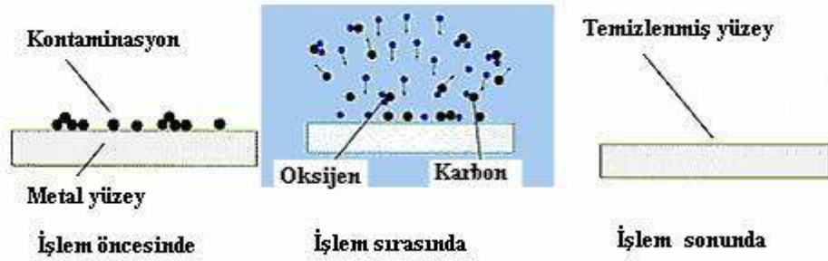
Şekil 3.14 Plazma ile elde edilen temizlenmiş yüzey
