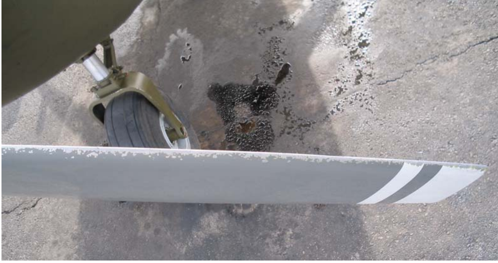
Resim 4.3. Pervane çatlak çentik hücum kenarı görüntüsü [21]
