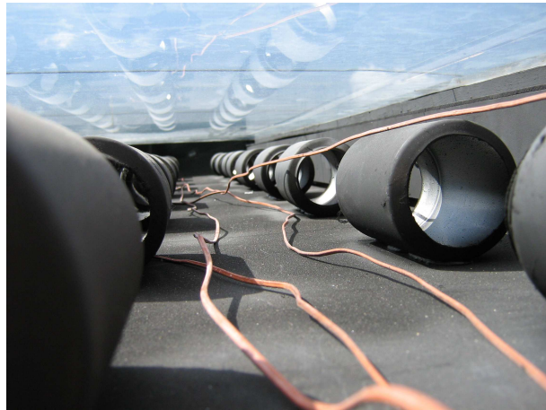
Şekil 6.6. Tip II' in yutucu yüzeyinin kasa içindeki görünüşü
