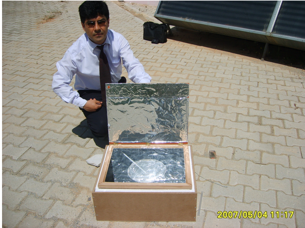
Şekil.4.9. Isı Kutulu Güneş Ocağı ile deneyin yapılışı
