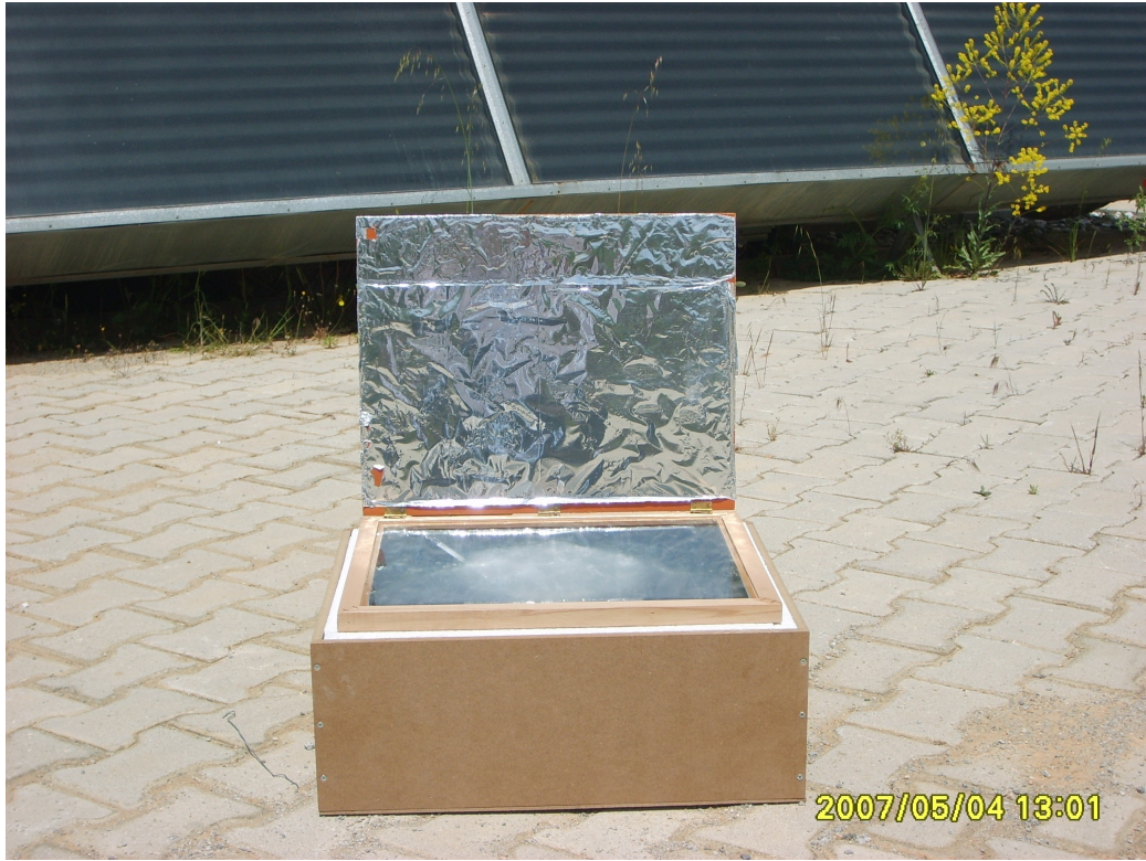
Şekil 4.8. Isı Kutulu Güneş Ocağı
