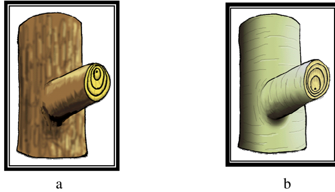
Şekil 1.2 Dallarda basınç ve çekme odununun görünümü. a: Basınç Odunu, b: Çekme Odunu (UTK, 2006).
