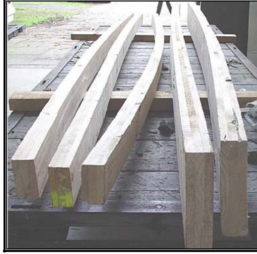
Şekil 1.14 Basınç odununun lamine levhalarda meydana getirdiği eğrilik ( Forestry, 2007b ).
