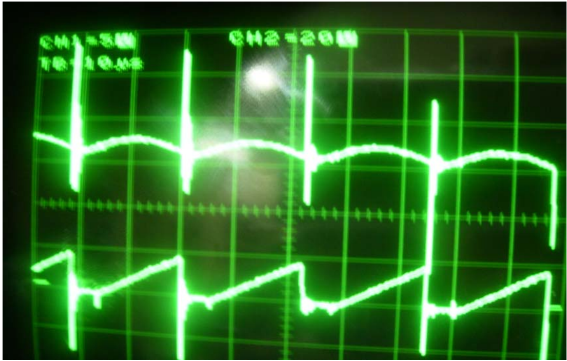
Şekil 5.17 Doğrultulmuş giriş gerilimi ile R11 direnci üzerindeki dalga şekilleri
