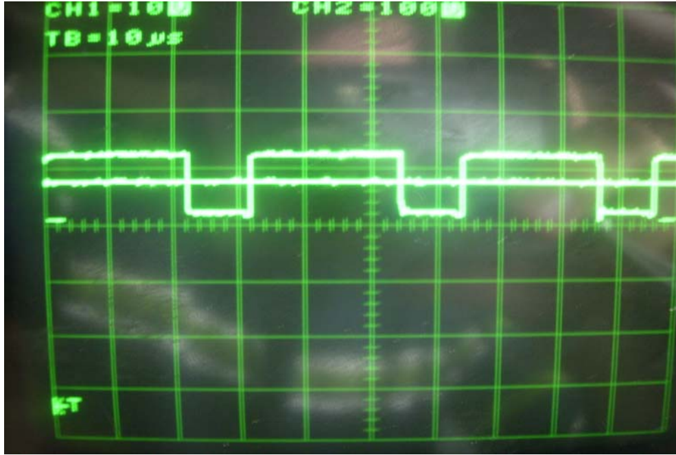
Şekil 5.11 Kapı sürücü çıkışı (bacak7) dalga şekilleri
