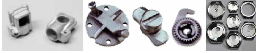
Şekil 2.6 Elektronik endüstrisinde kullanılan TEK parçalara örnekler (Arslan, 2007).
