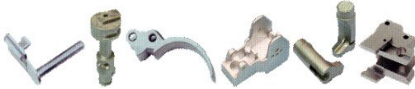
Şekil 2.5 TEK kullanılarak imal edilen bazı ateşli silah parçaları (Arslan, 2007).
