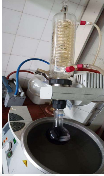
Şekil 4.20 ATPE ile ayrılan üst faz antosiyaninlerinden etanolün evaporatör ile uzaklaştırılması
