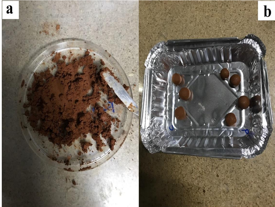
Şekil 2.5: a) Çamur Hazırlama İşlemi, b) Hazırlanan Agregalar
