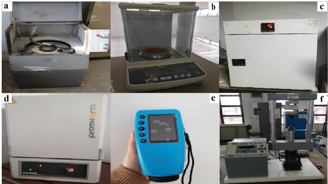
Şekil 2.3: a) Halkalı Değirmen, b) Hassas Terazı, c) Etüv, d) Fırın, e) Renk Ölçüm Cihazı, f) Tek Nokta Yükleme Cihazı
