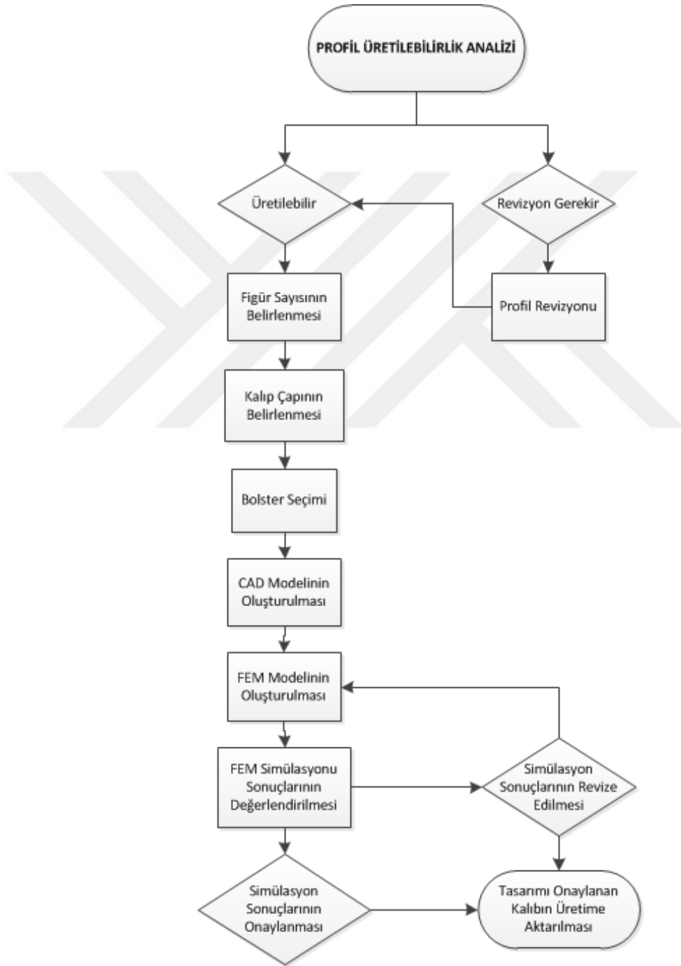
Şekil 3.12. Kalıp Üretimi Planlama Akış Şeması
