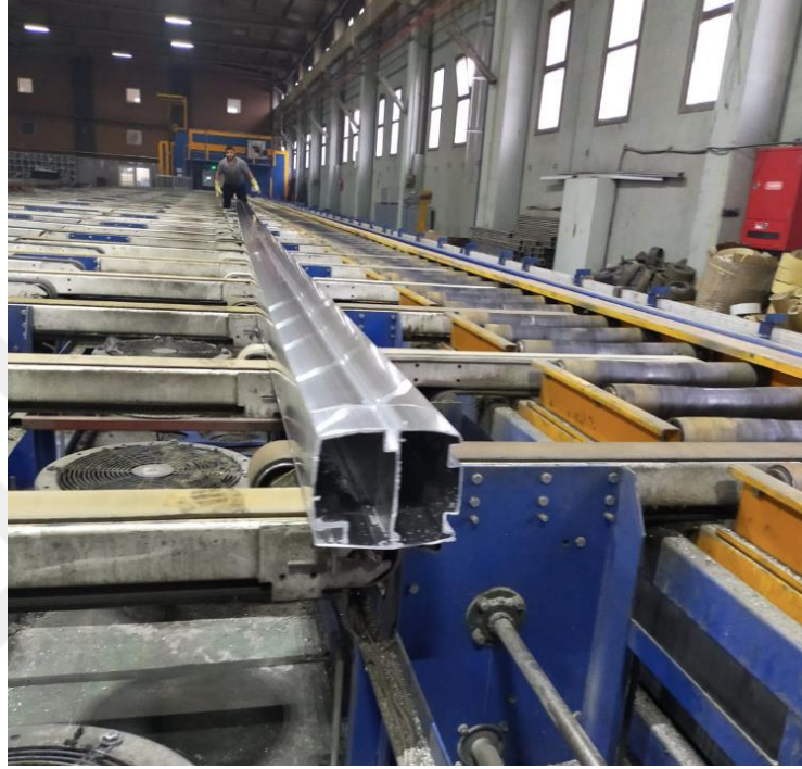
Şekil 4.3. Profilin Kalıp Çıkış Görüntüsü
