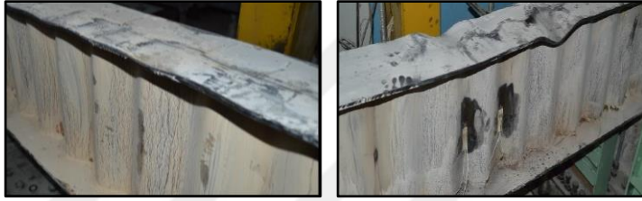
Şekil 2.10. Basınç flanşı lokal burkulma (Tunca 2019)
