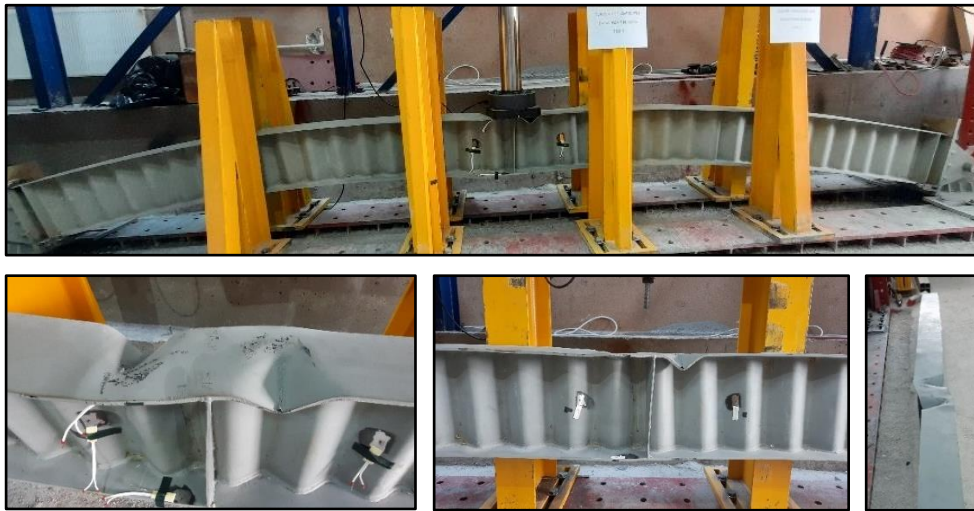
Şekil 4.37. OGK350-E tek noktadan yükleme, test 02 göçme modları
