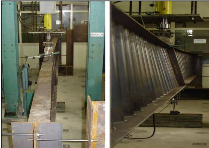
Şekil 2.47. Yanal burulmalı burkulma durumu (Pimenta vd. 2015)
