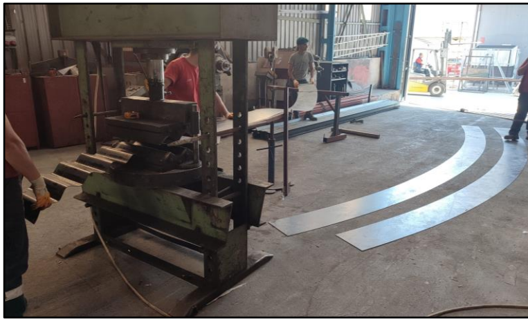
Şekil 3.10. Eğrisel formda gövde sacının kesilmesi
