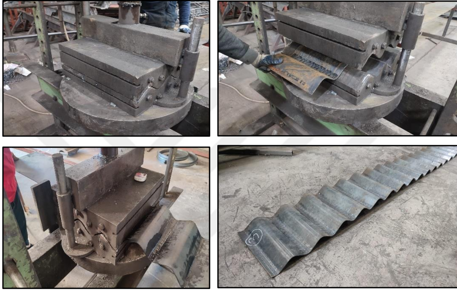
Şekil 3.9. Ondülin gövde kalıbı ve sinusoidal formun elde edilmesi
