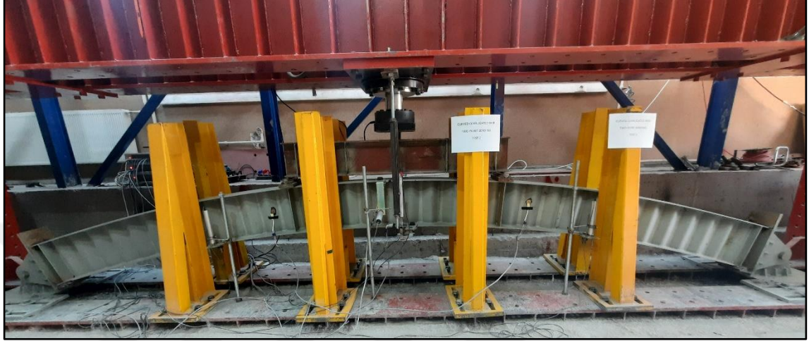
Şekil 3.13. Yükleme çerçevesi altında eğrisel ondülin gövdeli kiriş test düzeneği
