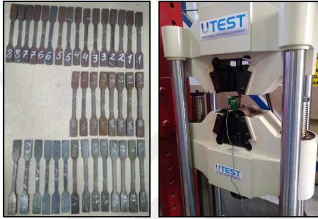
Şekil 3.20. Alınan numuneler ve çekme test cihazı
