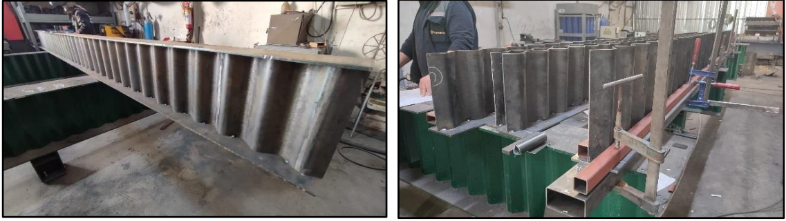
Şekil 3.11. Ondülin gövde ve flanşların sabitlenmesi
