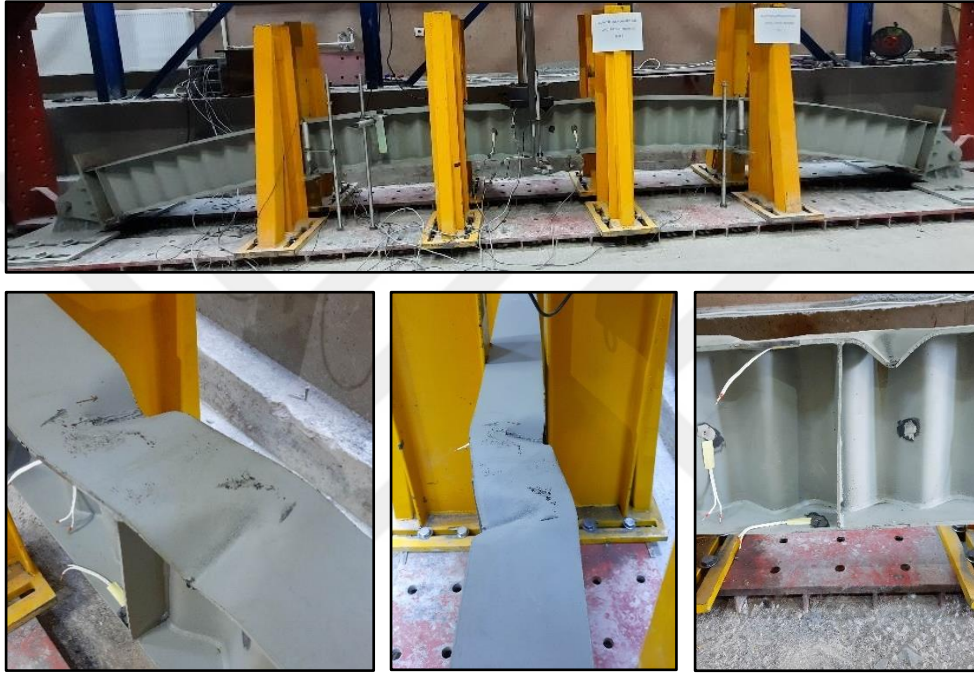
Şekil 4.36. OGK350-E tek noktadan yükleme, test 01 göçme modları
