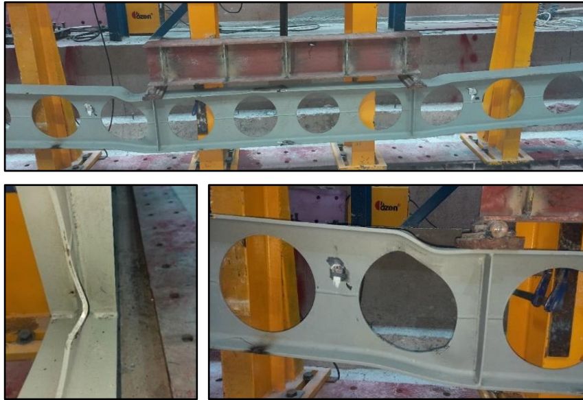
Şekil 4.18. DBK350-D iki noktadan yükleme, test 02 göçme modları
