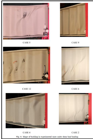
Şekil 2.38. Kesme yükleri altında burkulma şekilleri (Nikoomanesh ve Goudarzi 2020)
