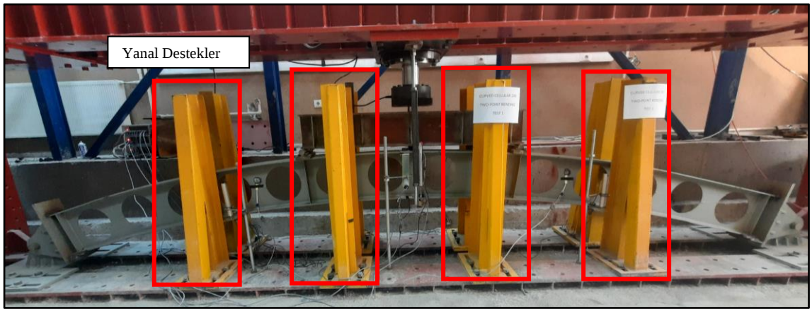
Şekil 3.14. Yanal desteklerin yerleşimi
