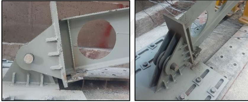
Şekil 3.17. Eğrisel kiriş testlerinde kullanılan sabit mesnet
