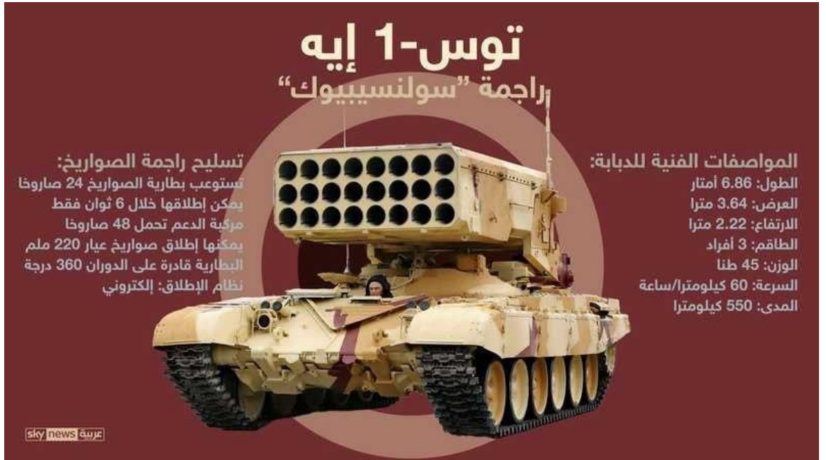
Şekil 2.13. TOS 1A Tankının (Solentsipyuk Fırılattıcı) Teknik Özelliklerini Gösteren Bir İnfografik
