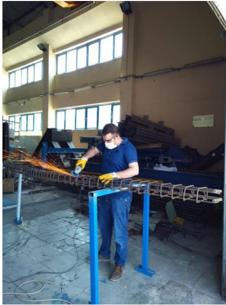
Şekil 2.2 Şekil değiştirme ölçerlerin donatılara uygulanması
