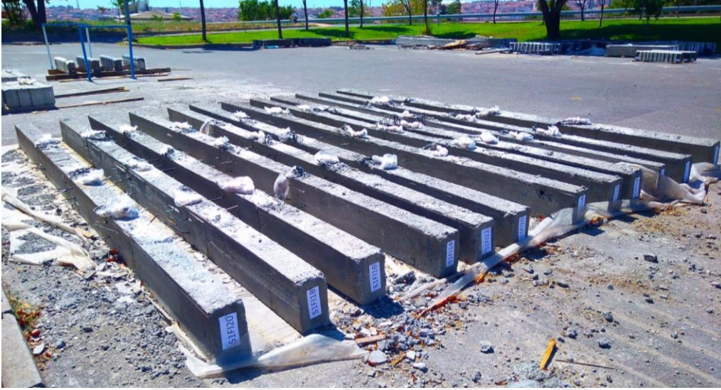
Şekil 2.6 Kirişlerin kalıptan çıkarılarak deneye hazır hale getirilmesi
