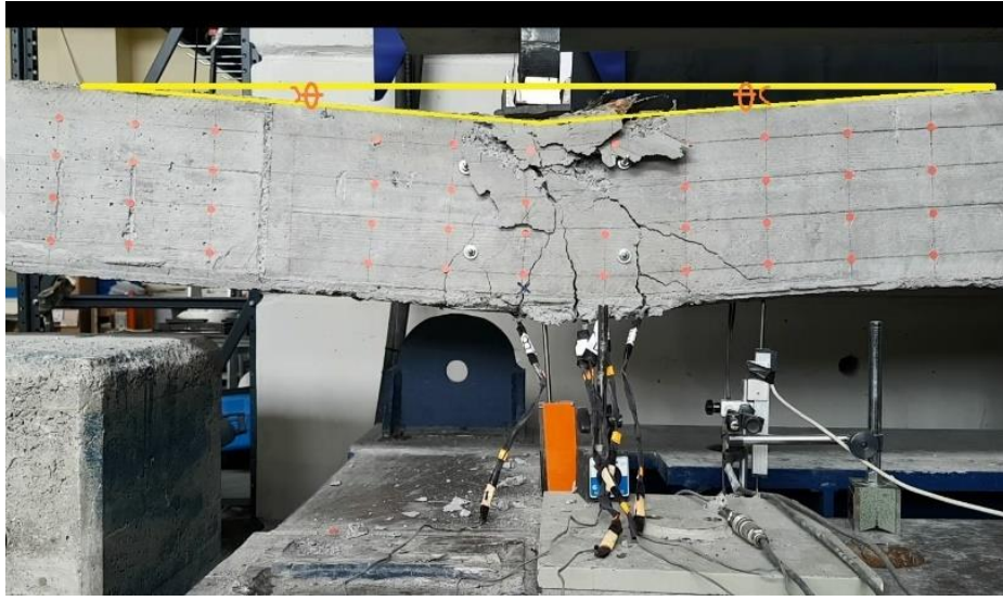
Şekil 3.9 Örnek bir sürekli kiriş üzerinde açıklık kesitinin her iki tarafında meydana gelen dönmelerin incelenmesi (T10C08 kirişi)
