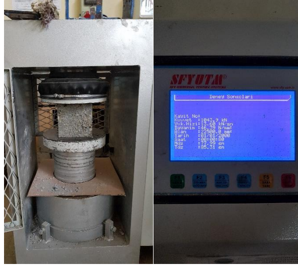
Şekil 2.7 Beton basınç deneyi örneği
