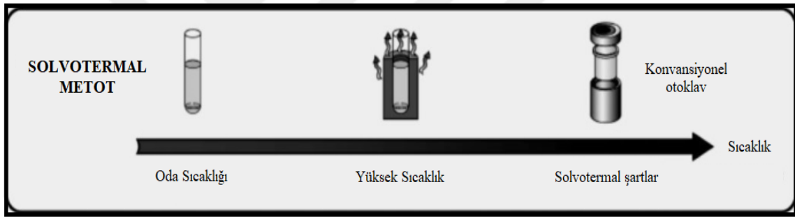
Şekil 1.16 Solvothermal üretim sürecinin özellikleri
