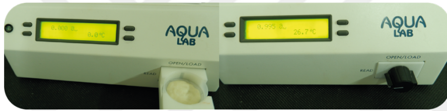
Şekil 3.3 Su aktivitesi cihazı ve ölçümü
