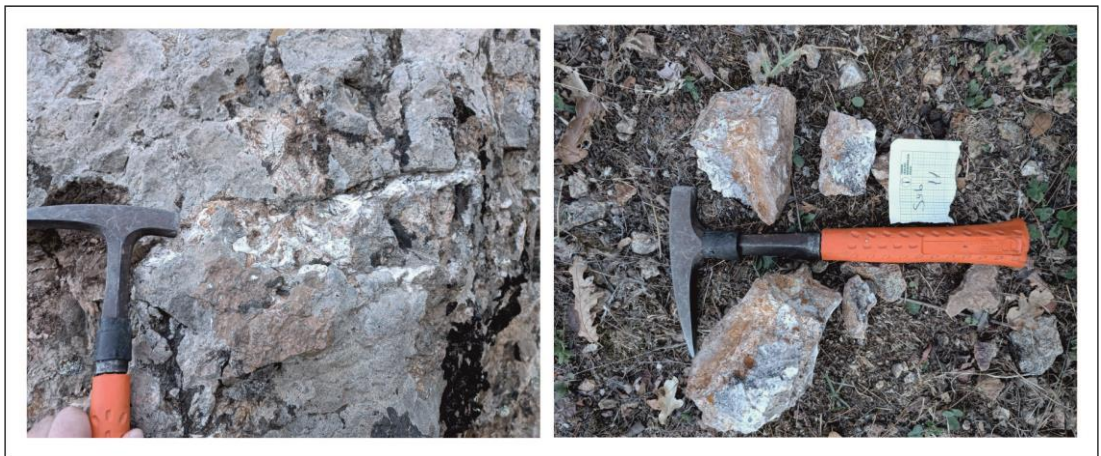
Şekil 5.5 Kırık hattı boyunca gelişen silis damarı ve bu zondan alınan cevherli kayaç örnekleri
