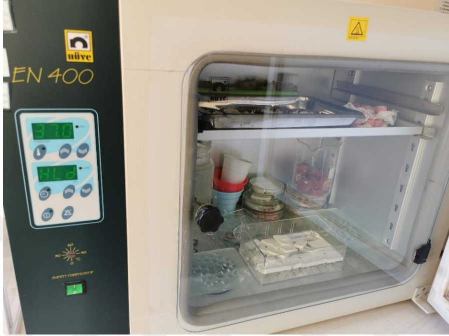
Resim 32: 37°C derece ayarlı etüv (Ege Üniversitesi Diş Hekimliği Fakültesi Araştırma Laboratuvarı)
