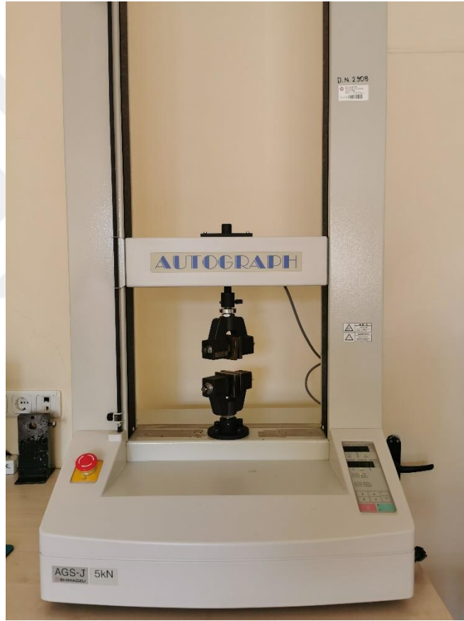
Resim 33: Üniversal test cihazı (Autograph AGS-J, Shimadzu®, Kyoto, Japonya)
