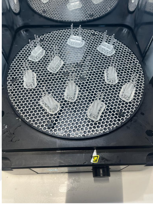
Resim 23: Blokların mekanik özelliklerini iyileştirmek için gerçekleştirilen kürtleme işlemi (Form Cure, Formlabs®, Somerville, MA, ABD)
