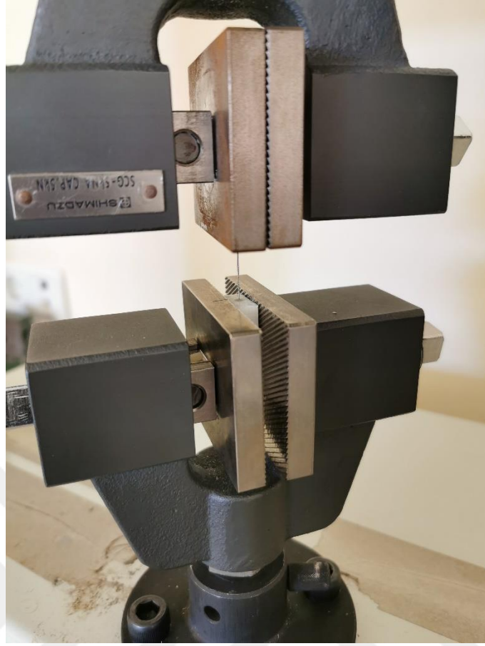
Resim 34: Üniversal test cihazının tutucu uçları arasına yerleştirilmiş bir örnek
