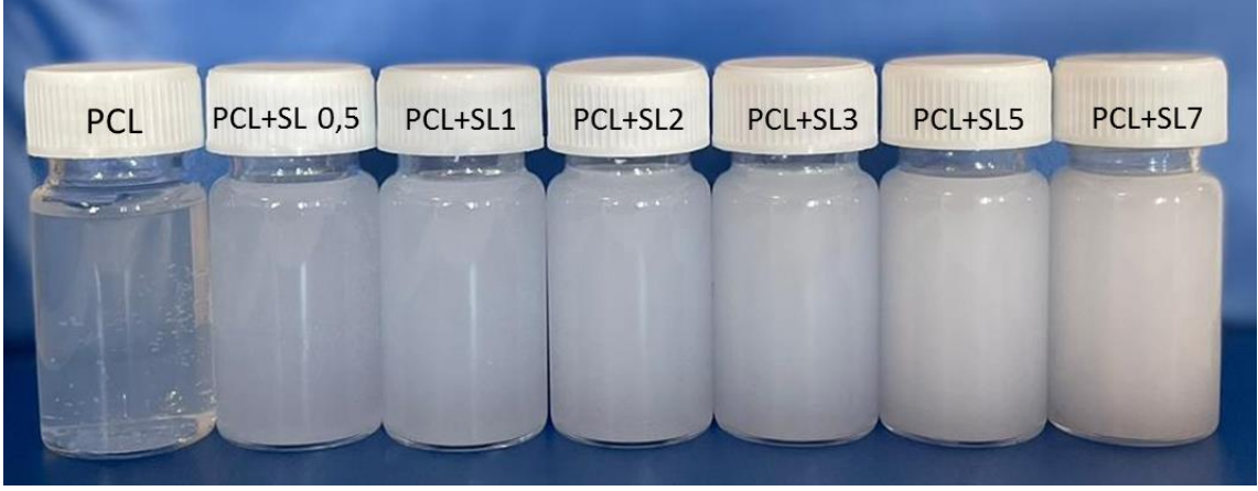
Resim 4.2. Basit nanoçöktürme yöntemi sıgla yağı dolgusuz/dolgulu PCL kolloidal dispersiyonların görünümü.
