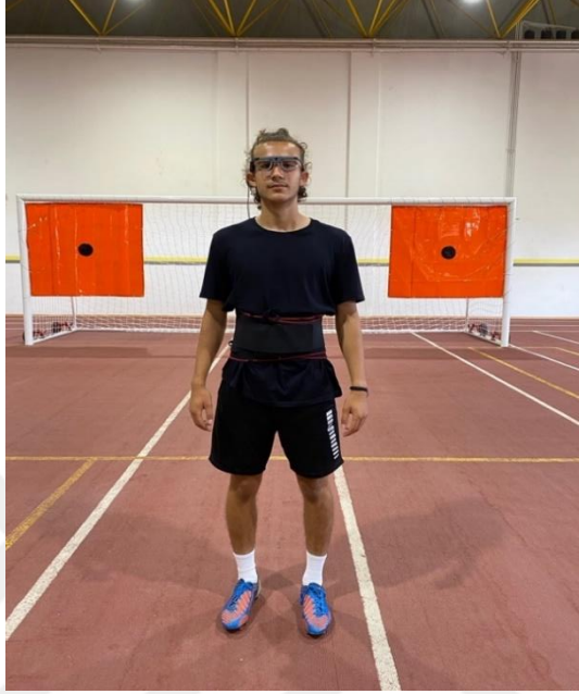
Görsel 3.3. Göz Takip Sisteminin Katılımcı Üzerindeki Görseli
