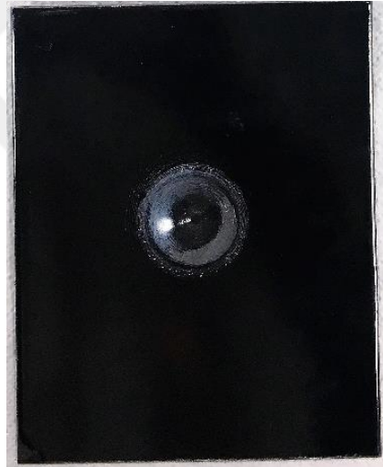
Şekil 3.8: Pirolitik testinden geçememiş plaka yüzeyi
