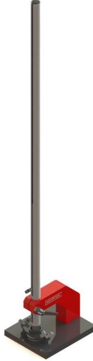
Şekil 3.2: İç haznesindeki ağırlık değiştirilerek farklı darbe tiplerine uyum sağlayabilen test cihazı
