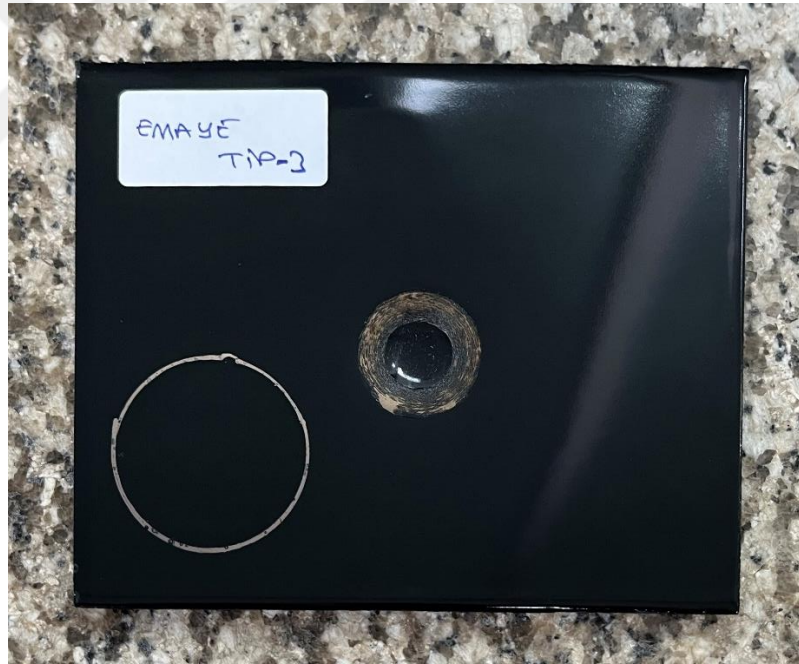
Şekil 4.12: Pirolitik özelliğe sahip emayenin lityum nitrat test sonucu.
