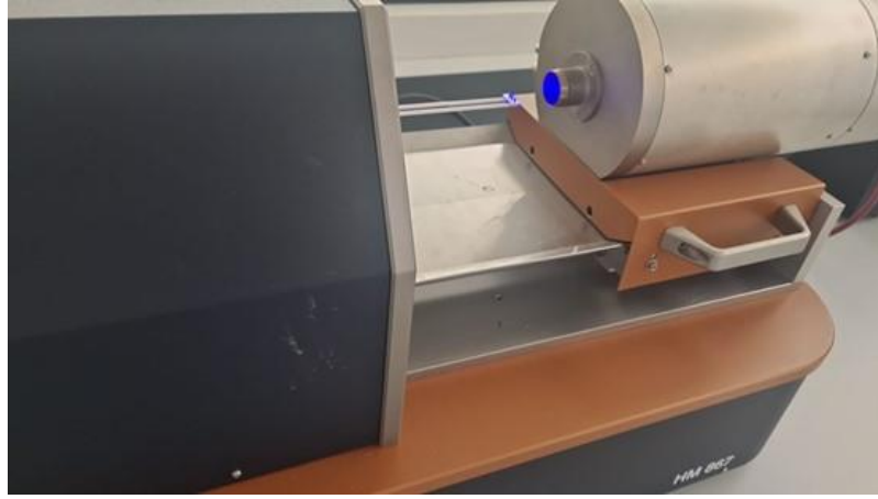
Şekil 3.10: Diferansiyel taramalı kalorimetre cihazı.
