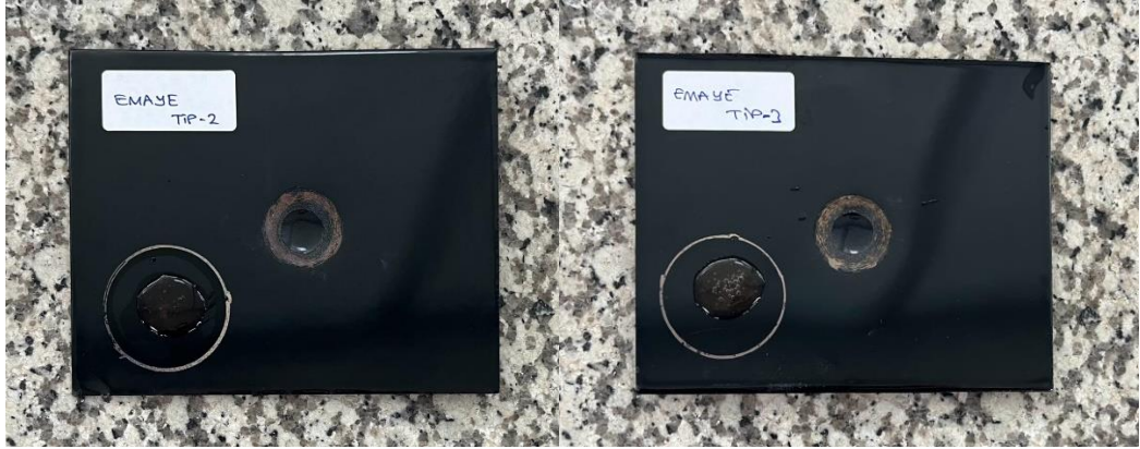
Şekil 4.13: Sırasıyla kolay temizlenebilir ve pirolitik özelliklere sahip ürünlere ketçap testi uygulamaları.
