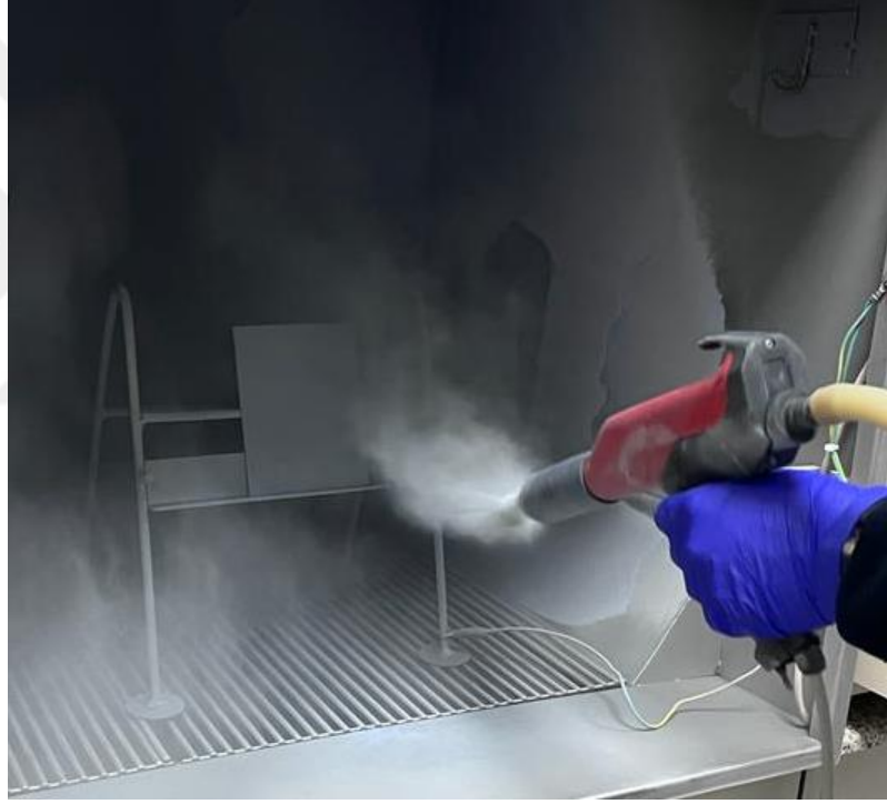
Şekil 4.1: Altık malzeme üzerine elektrostatik toz emayenin uygulanması.
