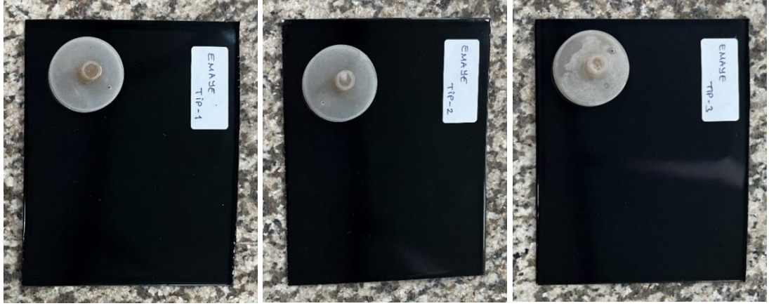
Şekil 4.5: Sırasıyla asit mukavim, kolay temizlenebilir ve pirolitik özelliklere sahip emayelerin asit testi uygulamaları.
