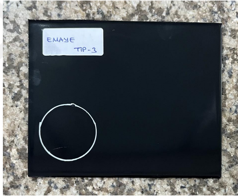
Şekil 4.8: Pirolitik özelliğe sahip emayenin asit test sonucu.
