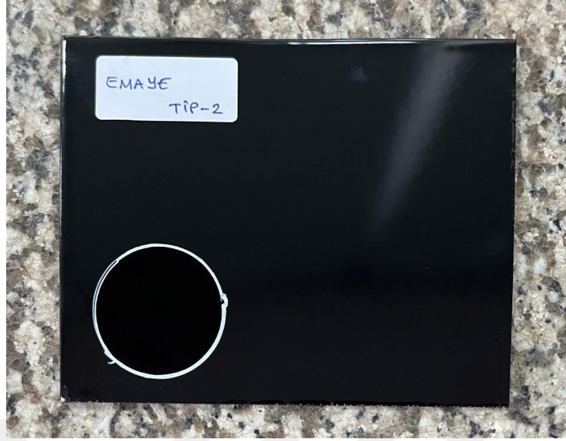
Şekil 4.7: Kolay temizlenebilirlik özelliğe sahip emayenin asit test sonucu.
