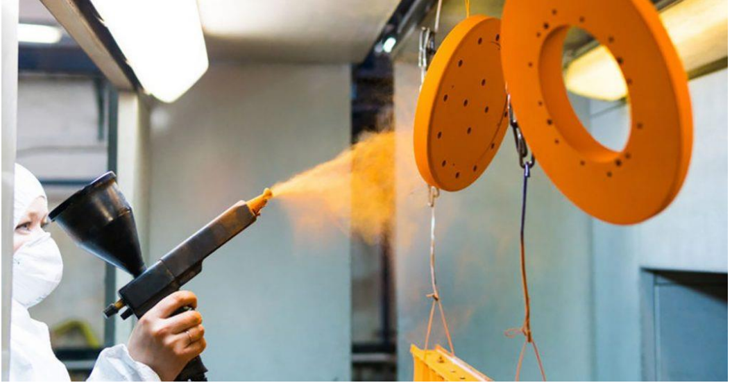
Şekil 2.3: Elektrostatik emayeleme uygulaması (Prospector Knowledge Center)
