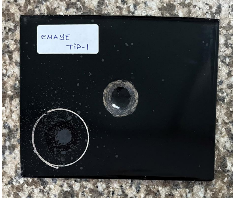
Şekil 4.10: Asit mukavim özelliğe sahip emayenin lityum nitrat test sonucu.
