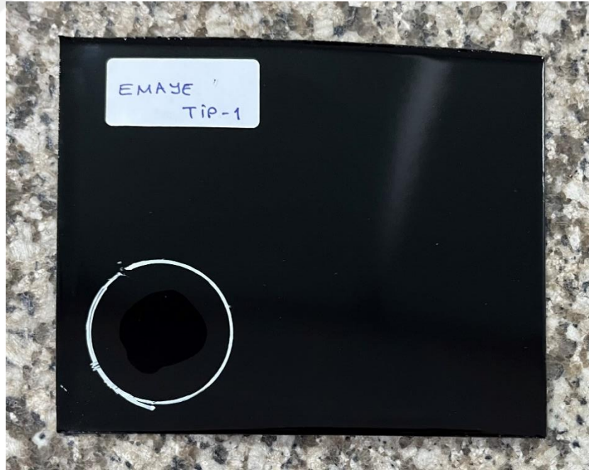
Şekil 4.6: Asit mukavim özelliğe sahip olan emayenin asit test sonucu.
