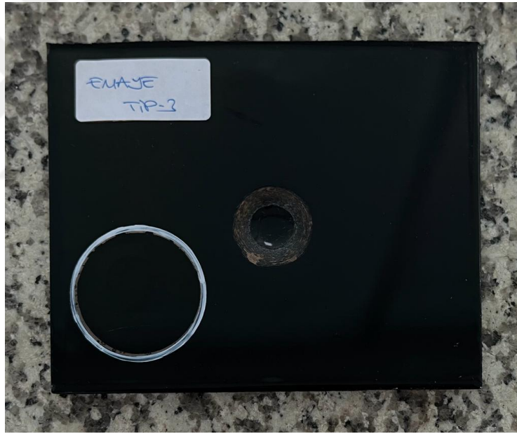
Şekil 4.16: Pirolitik özelliğe sahip emayenin ketçap testinin ardından tahta parça ile kazınan yüzey görüntüsü.
