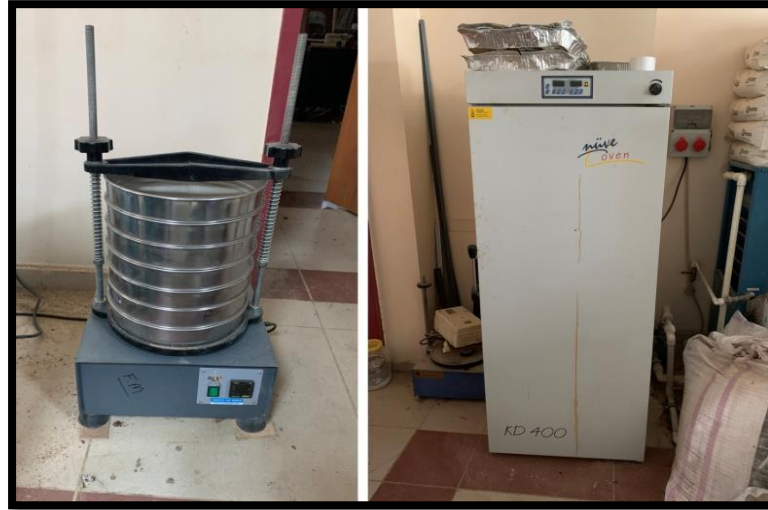
Şekil 3.7. Çalışmada kullanılan malzemelerin ön hazırlık aşaması a) Sarsak Elek b) Etüv Fırını
