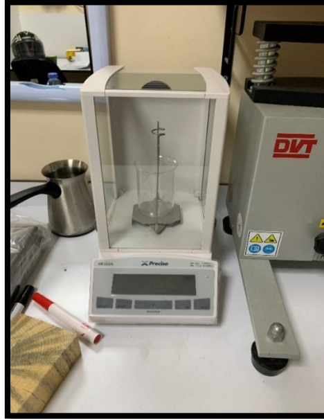
Şekil 3.12. Yoğunluğun belirlenmesinde kullanılan deney düzeneğinin görüntüsü
