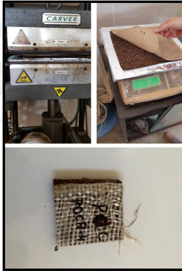
Şekil 3.9. Opk kalıplanması a) Sıcak pres makinası b) Pres öncesi hazırlık c) Elde ettiğimiz son ürün
