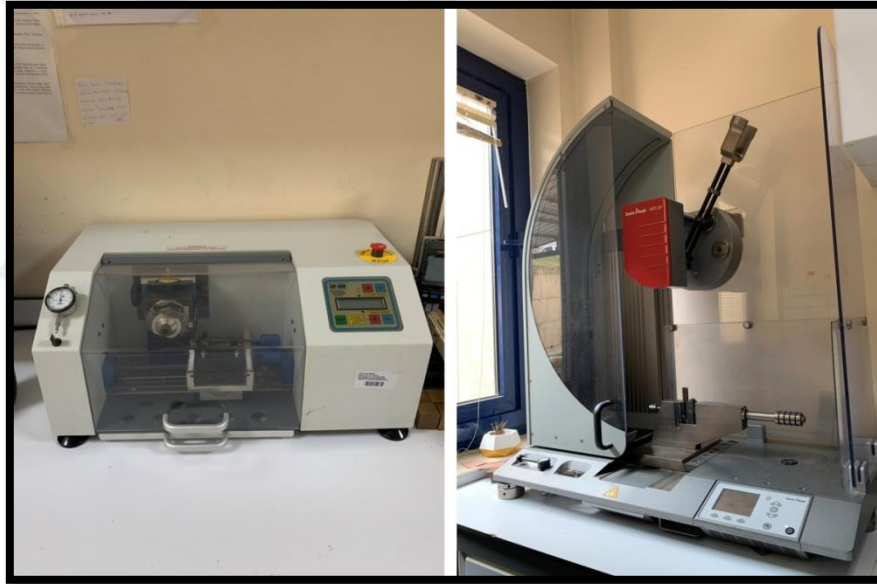
Şekil 3.15. Darbe direnci a) Çentik açma cihazı b) Darbe test cihazı
