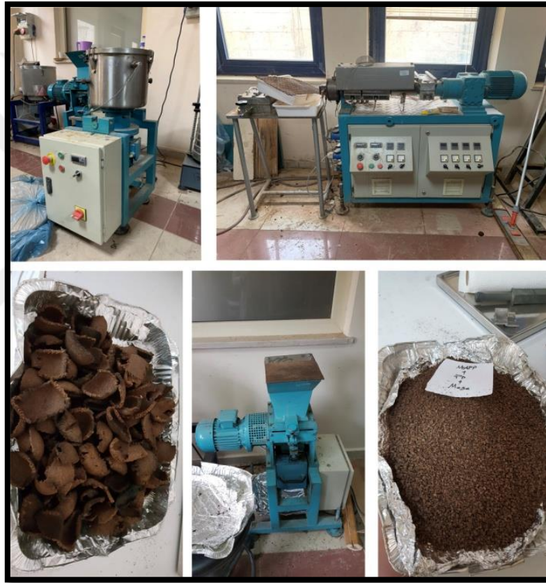
Şekil 3.8. Kullanılacak ekipmanlar a) Mikser, b) Ekstruder makinesi c) Ekstruder çıkan ürün d) Kırıcı e) Kırılmış haldeki pelet ürün
