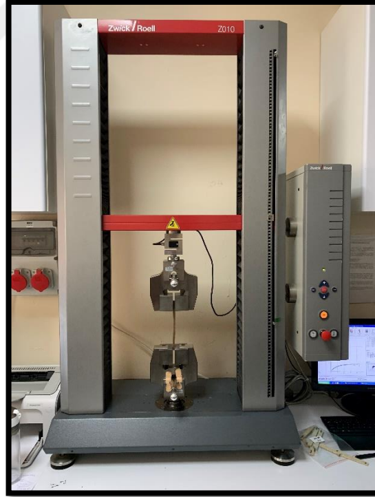
Şekil 3.13. Zwick/Roell Z1.0 çekme deneyi test cihazı
