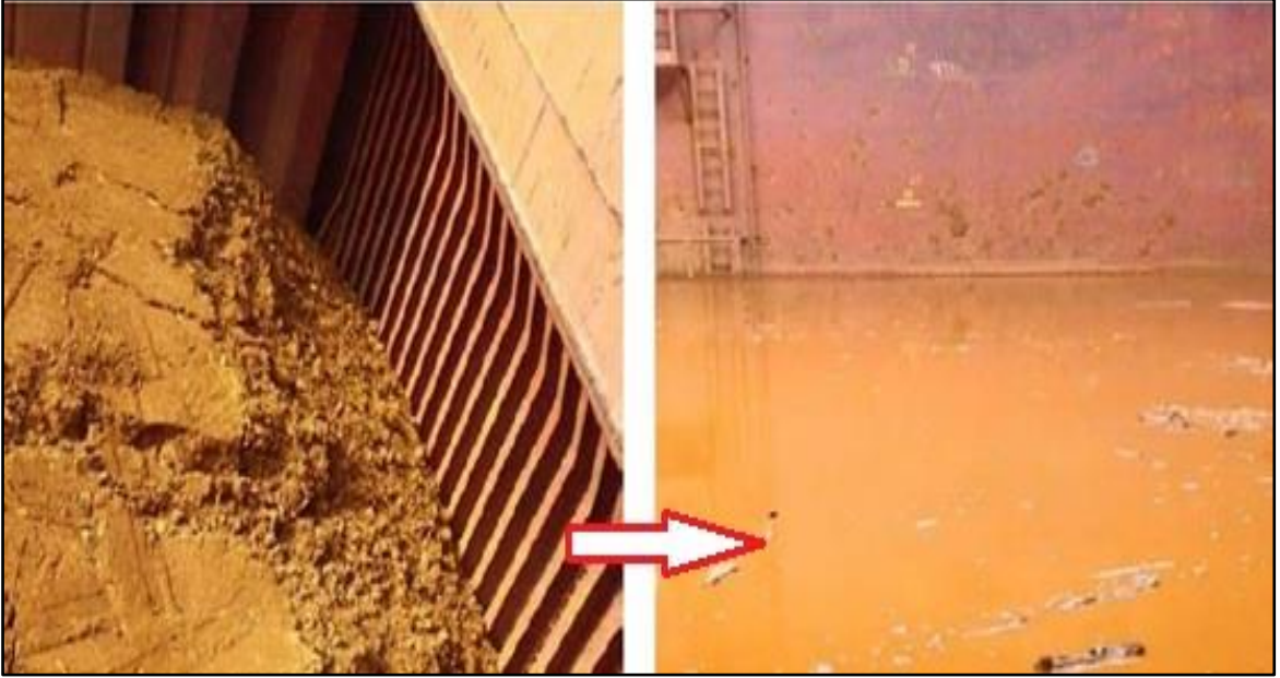
Şekil 23. Padang Hawk gemisinin 1 numaralı yük ambarının içindeki kuru ve sıvılaşmış cevher fotoğrafları (DNV-GL, 2019)
