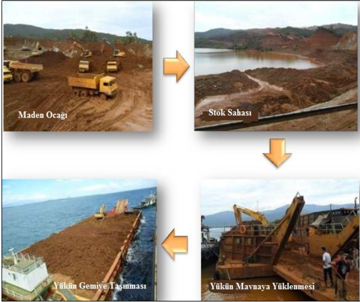
Şekil 20. Nikel Madeni Yükünün Maden Ocağından Gemiyeye Taşınma Süreci (PPI, 2020)
