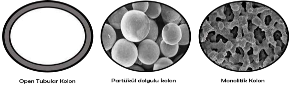
Şekil 2.4. Analitik nano kolon türleri soldan sağa a) Açık tubular, b) Partikül dolgulu ve c) Monolitik kolonlar
