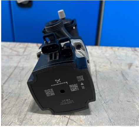
Resim 4.12. Sıcak suyun üretimini ve dağıtımını sağlamak için devir daim yapan pompa
