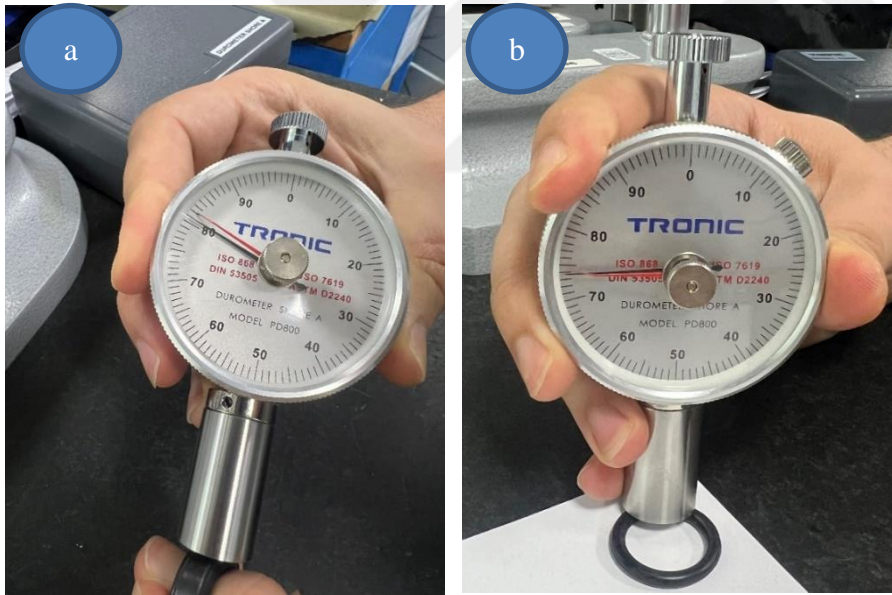
Resim 4.17. Çizelge 4.1’de yer alan birinci O-ringe (a) ve onuncu O-ringe (b) ait sertlik ölçümü
