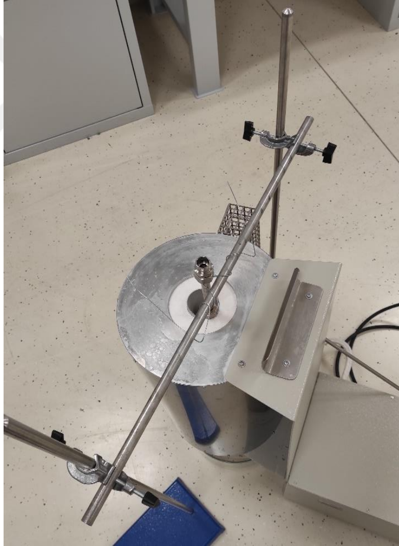
Şekil 3.4: Deneyin başlangıcında tuzun erimesi için kullanılan fırın
