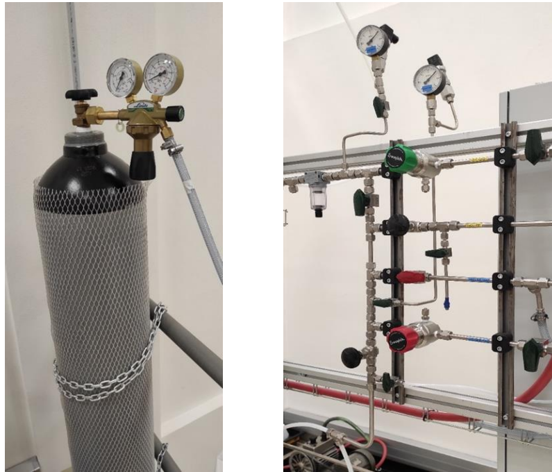
Şekil 3.11: Basınçlandırma tüpü ve basınçlandırma sistemi
