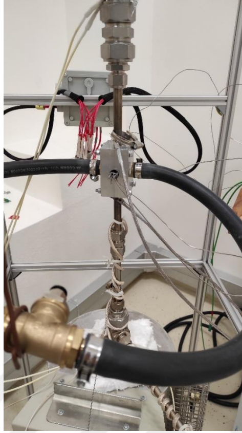
Şekil 3.12: Tıpa soğutma sistemi
