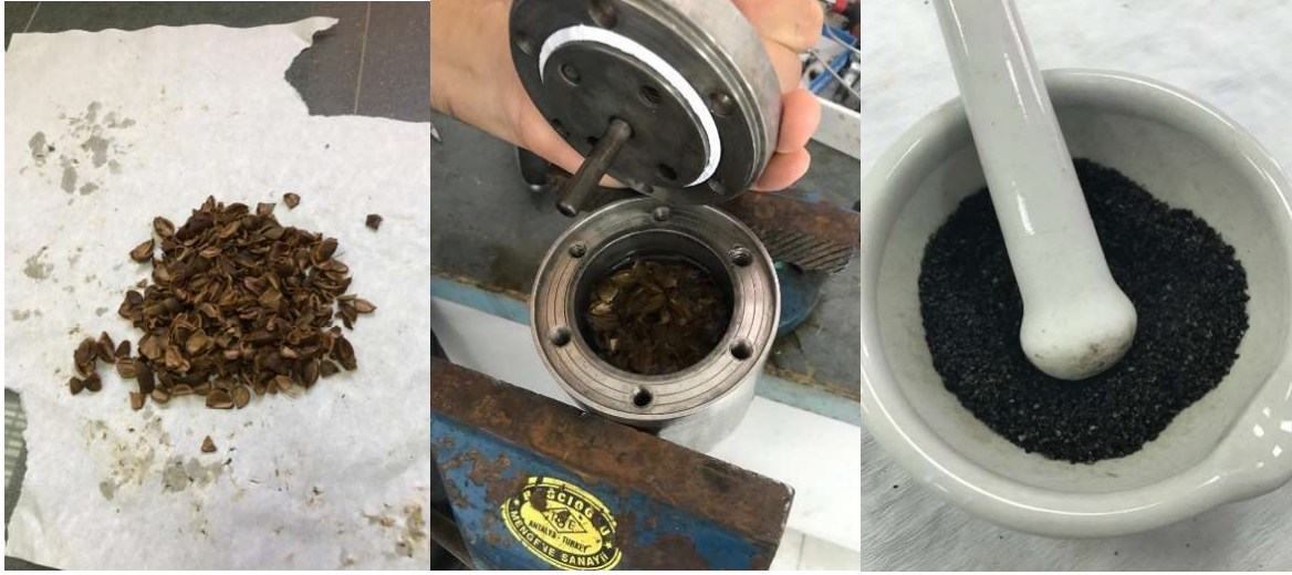
Şekil.3.2. Kayısı çekirdeğinin hidrokömür sentez basamakları görüntüsü
