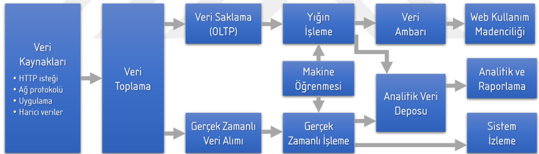
Şekil 3.4. CAWAL modelinde veri akışı ve işleme süreçleri.
