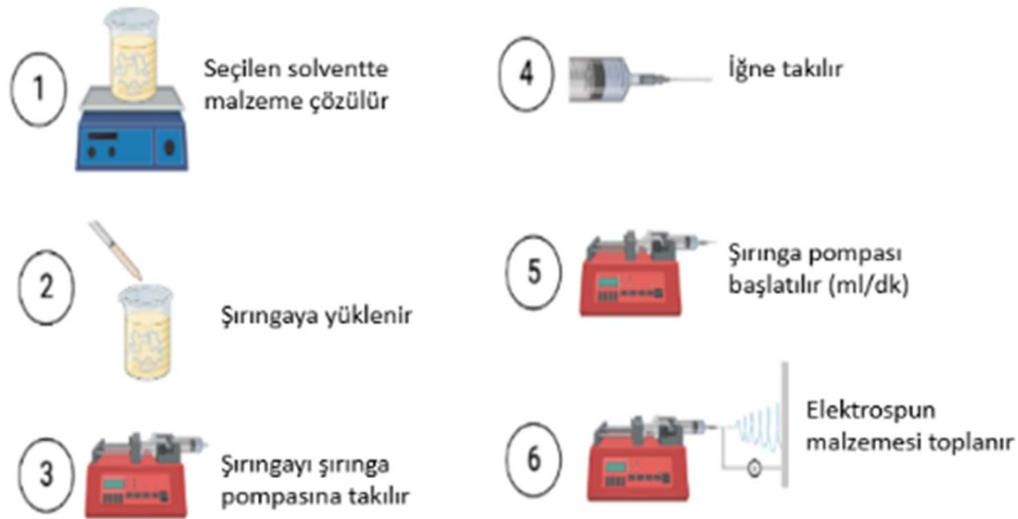
Şekil 7. Elektroegirme yöntemi ile üretime hazırlık ve yöntem.
