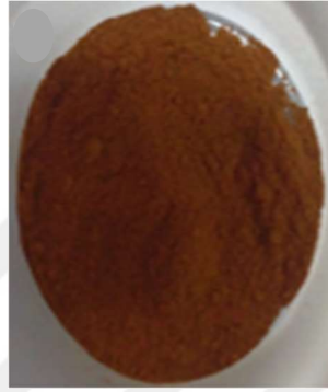
Şekil 5. Sentez Sonucu Bizmut Ferrit partikülleri.
