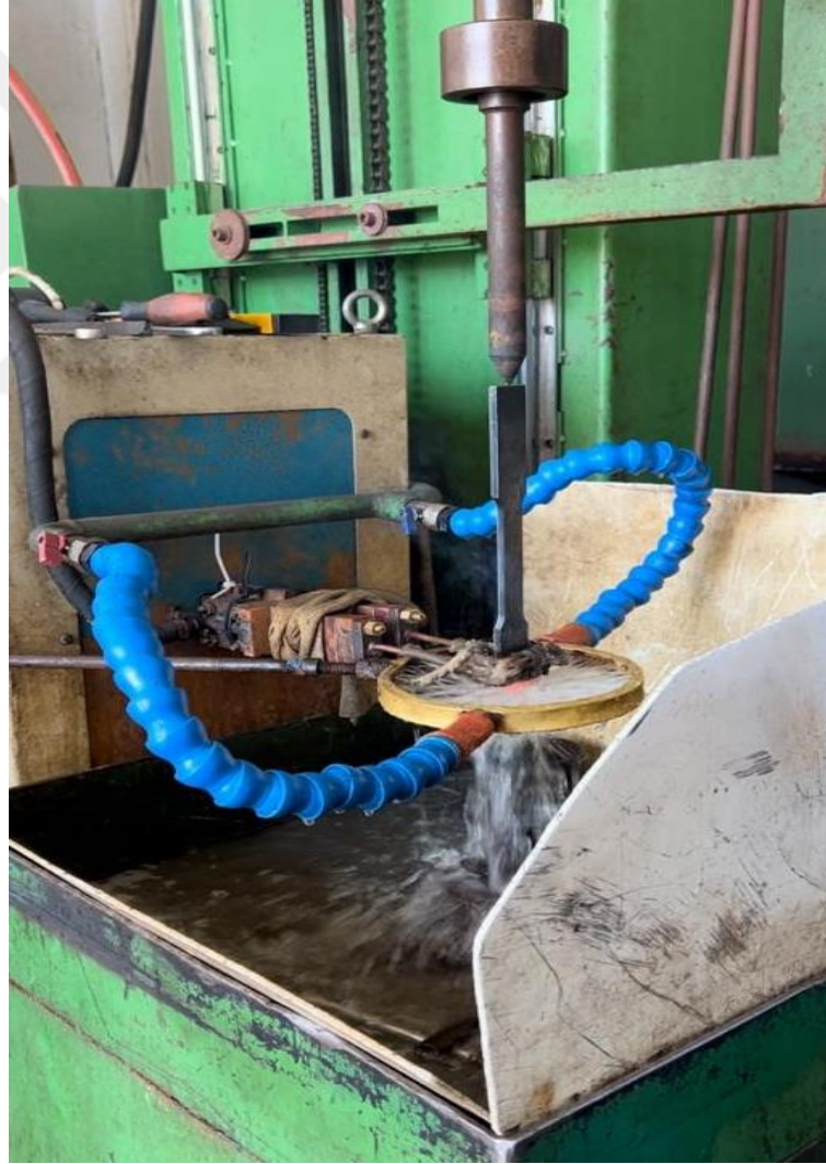
Şekil 3.9. Malzeme yüzeyine uygulanan indüksiyon işlemi
