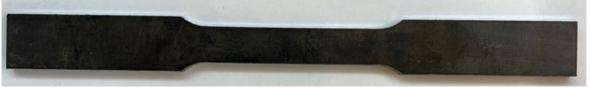
Şekil 3.11. Lazer kesim işlemi yapılmış S235JR malzeme görüntüsü
