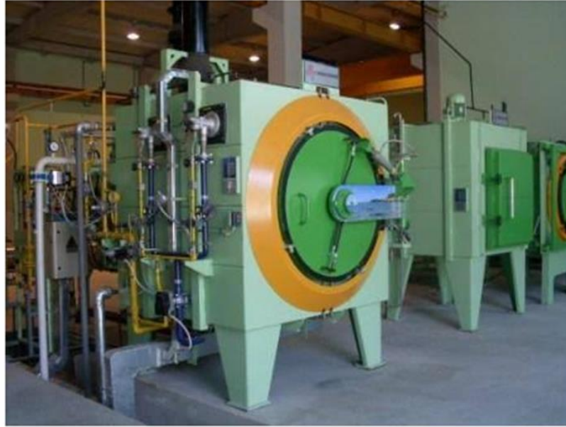
Şekil 3.8. Nitrürleme işleminin gerçekleştirildiği vakum fırını
