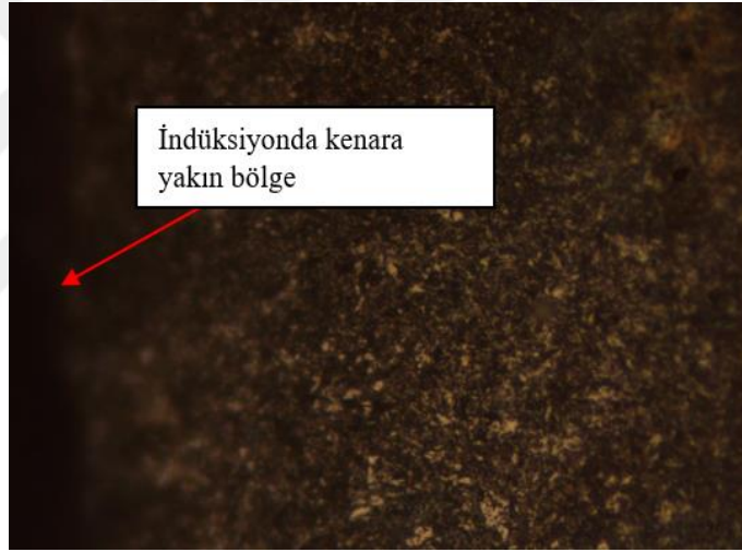
Şekil 3.5. 500x dađlama sonrası kenara yakın bölge indüksiyon bölge
