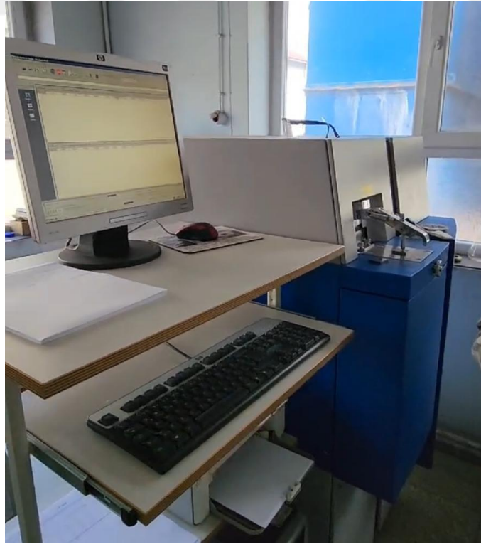
Şekil 3.6. Spektral kimyasal analiz cihazı
