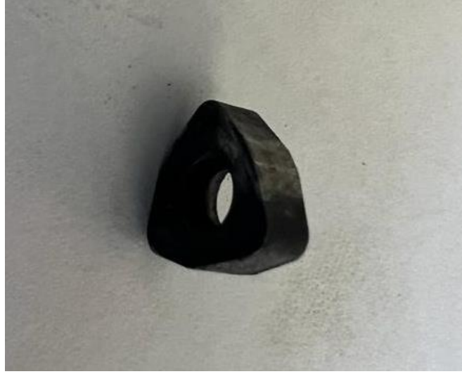
Şekil 3.19. Korloy marka WNMX09T316 kodlu bir karbür uç
