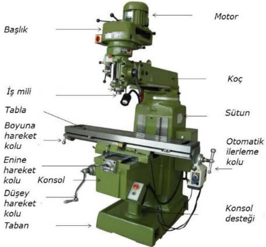
Şekil 2.11. Frezeleme işleminde kullanılan düşey freze tezgâhı (Yaldız, n.d.)
