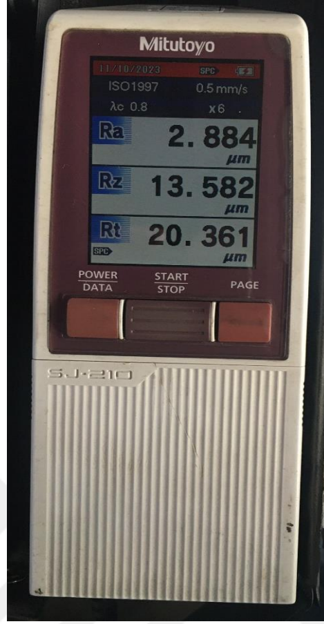
Şekil 3.21. Ortalama yüzey pürüzlülük Ra ölçüm cihazı
