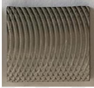
Şekil 4.15. S235JR 2000 ilerleme miktarında frezeleme işlemi yapıldıktan sonraki görüntüsü
