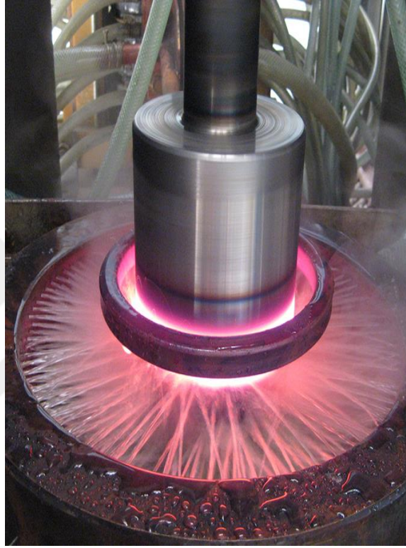
Şekil 2.19. İndüksiyon akımı ile sertleştirme yapılan malzeme (Anonim, n.d.-b)
