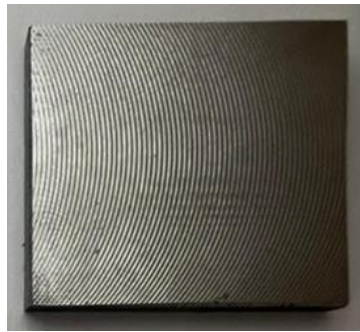
Şekil 4.16. S235JR 500 ilerleme miktarında frezeleme işlemi yapıldıktan sonraki görüntüsü
