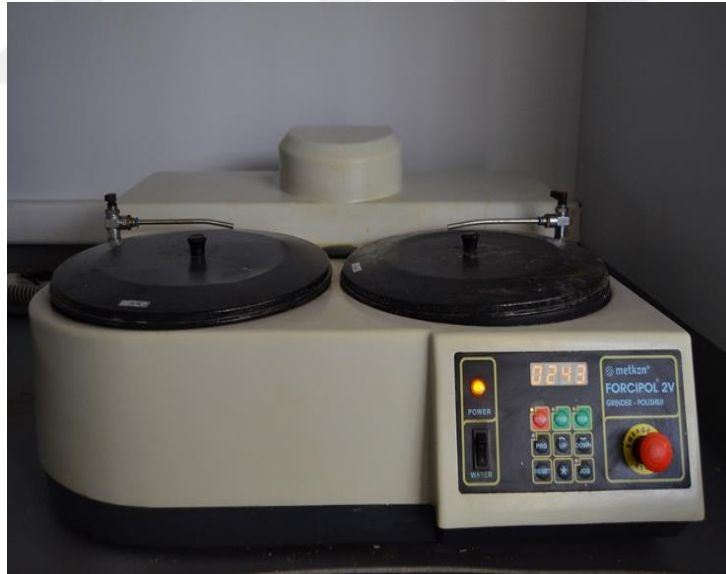
Şekil 3.15. Zımparalama ve parlatma cihazı
