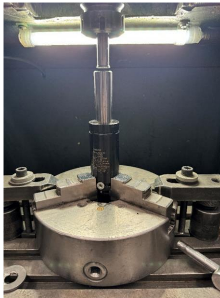
Şekil 3.21. Gaz yayı kuvvet eğrisi elde etme deneyi
