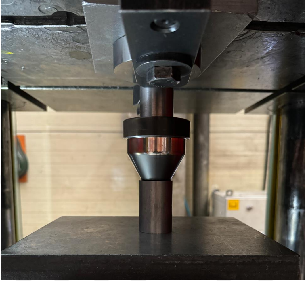
Şekil 3.11. Ağız genişletme deneyi
