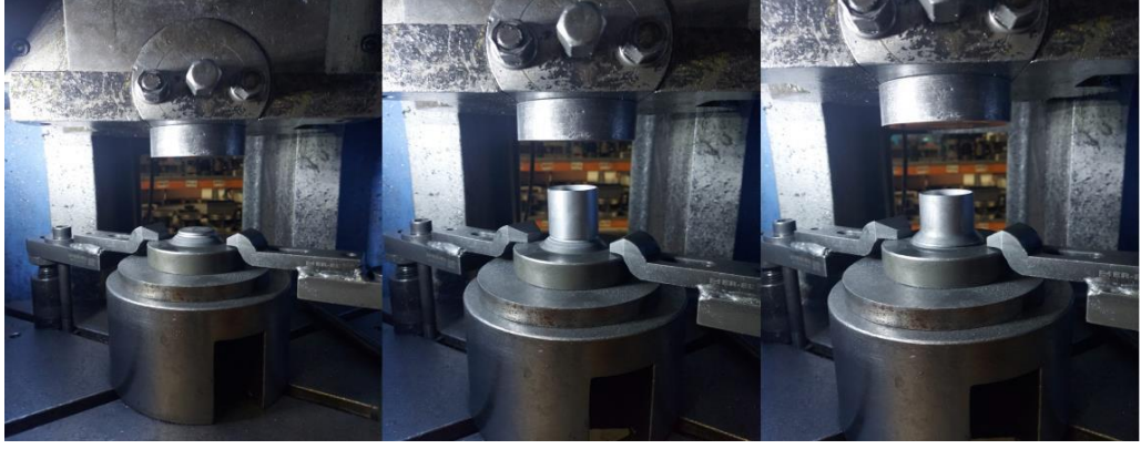
Şekil 3.12. Eksantrik prese bağlı boğaz açma kalıbı
