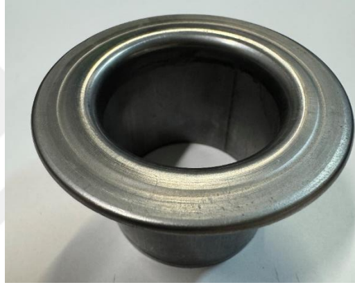
Şekil 4.35. Optimum kalıp çalışması sonucunda elde edilen flanşlı boru
