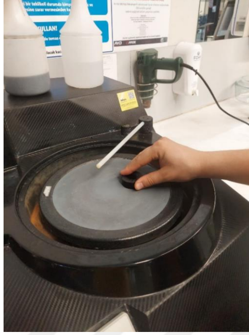
Şekil 3.6. PRESI MINITECH 250 DPI makinesinde yapılan zımparalama işlemi
