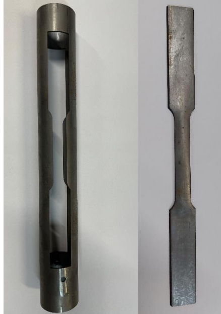
Şekil 3.4. Çekme deney numunelerinin hazırlanışı
