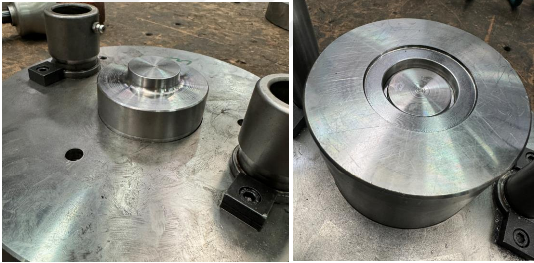
Şekil 4.33. Üst kalıbın montajı
