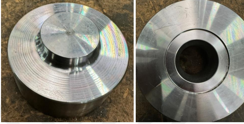
Şekil 4.32. Optimum kalıp çalışması sonrası imal edilen üst kalıp
