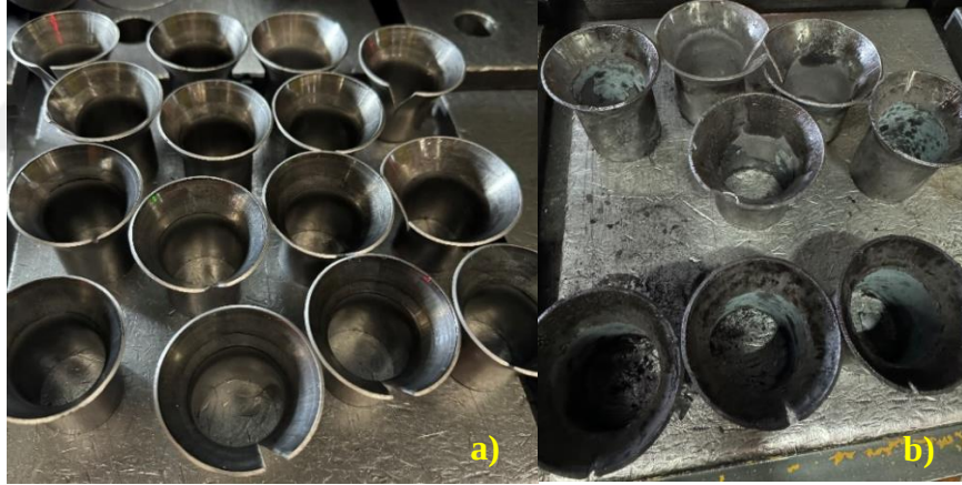
Şekil 4.8. Ağız genişletme deneyi uygulanmış numuneler a) S355JR-N olarak satın alınan borular, b) S355JR-N'ye tekrar normalizasyon işlemi yapılmış borular
