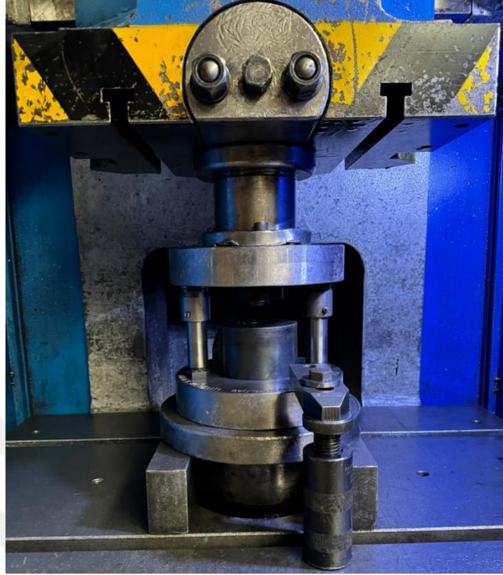
Şekil 4.34. Kalıp setlerinin prese bağlanması
