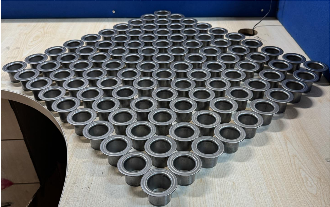
Şekil 4.36. Optimize edilmiş kalıplar ile üretilmiş 100 adet deney numunesi
