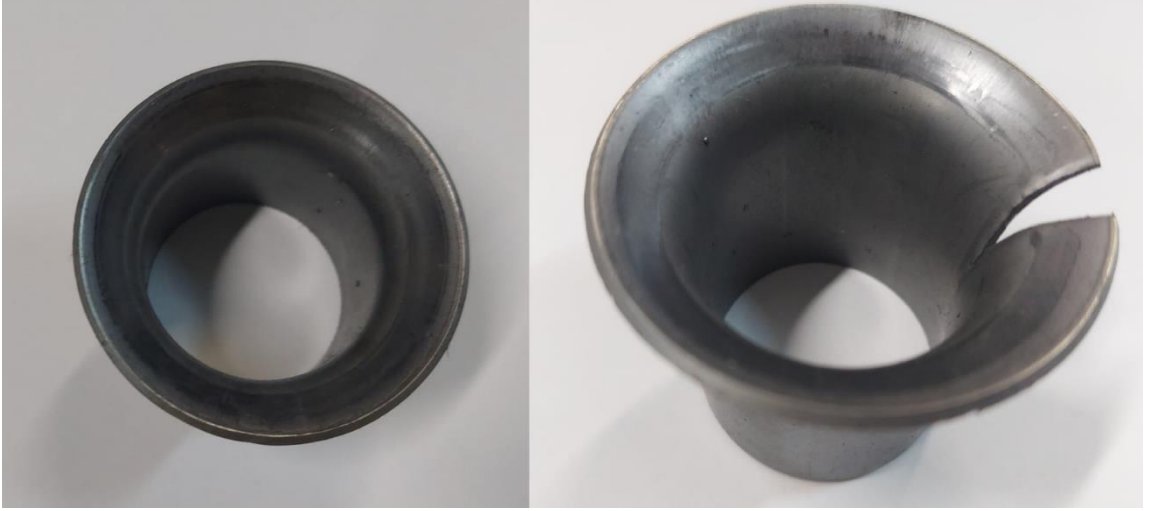
Şekil 4.30. Boğaz açma işlemi sırasında sağlam ve yırtılan boru örnekleri
