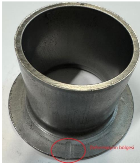
Şekil 4.31. 49,5 boya sahip borunun mevcut kalıpta şekillendirilmesi
