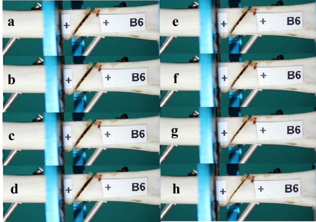
Şekil 3.2. B grubu 6 numaralı kemiğin aksiyel kompresyon sırasında kayıt edilen görüntüleri a) 0 N b) 5 N c) 10 N d) 20 N e) 40 N f) 60 N g) 100 N h) 150 N
