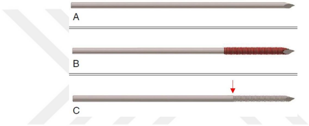
Şekil 1.26. Farklı uçlara sahip pin çeşitleri. A) Düz pin B) Pozitif profil Schanz pini C) Negatif profil Schanz pini. Kırmızı ok pinin en zayıf noktasını göstermektedir (Tobias ve Johnston, 2013)
